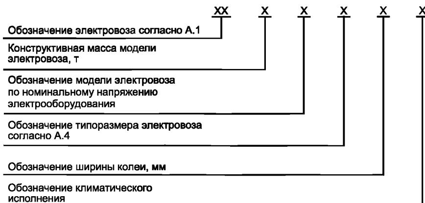
A.7 Пример условного обозначения модели электровоза рудничного контактного массой 10 т и напряжением 250 В, 2-го типоразмера по сцеплению с колеей шириной 900 мм, в климатическом исполнении Т:
