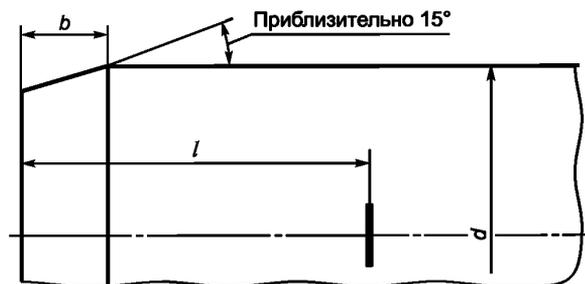
Рисунок 5 — Снятие фаски с конца трубы
