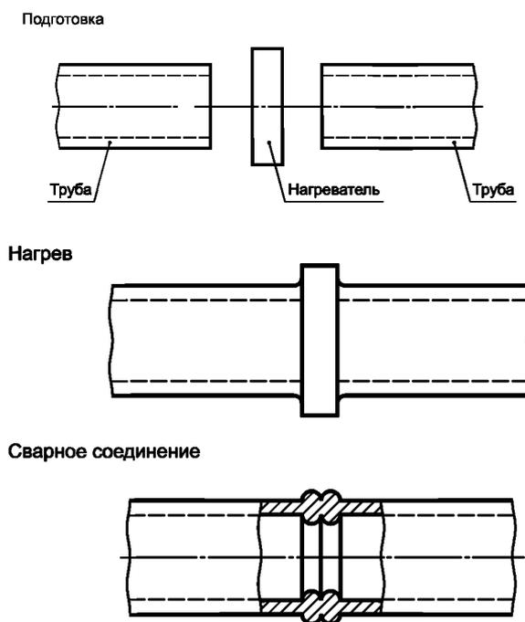
Рисунок 1 — Принцип сварки встык трубы нагретым инструментом
