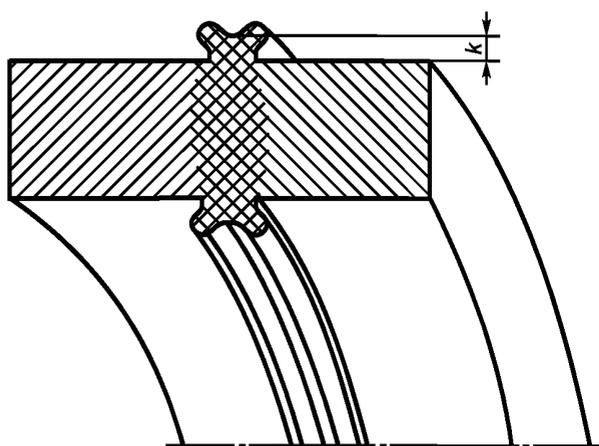
Рисунок 3 — Вид валика при сварке трубы нагретым инструментом
