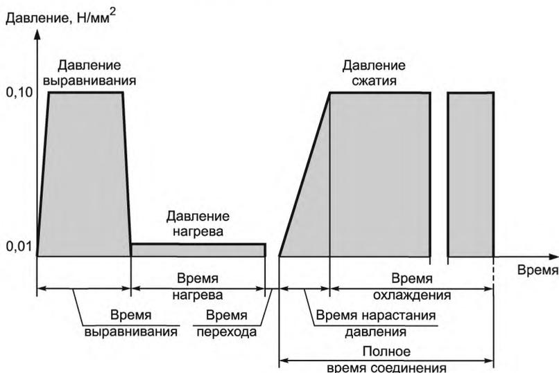
Рисунок 2 — Стадии процесса сварки нагретым инструментом встык
