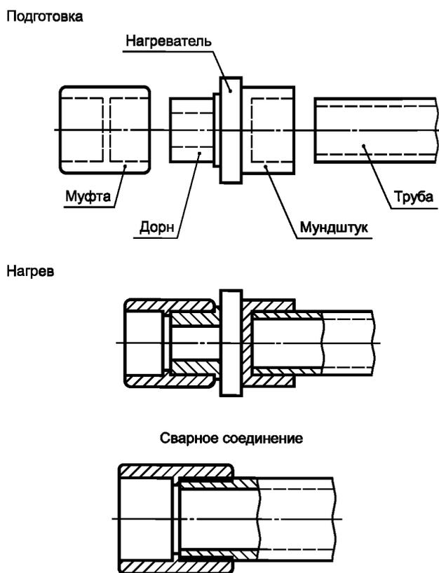
Рисунок 4 — Принцип сварки нагретым инструментом в раструб
