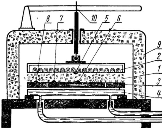
1.2. Тепловой поток от нагревателя через образец и малоинерционный тепломер передается холодильнику. Величина теплового потока, проходящего через центральную часть образца, измеряется тепломером, представляющим собой термобатарею на парнитовом диске, или тепломером с воспроизводящим элементом, в котором вмонтирован плоский электрический нагреватель.
