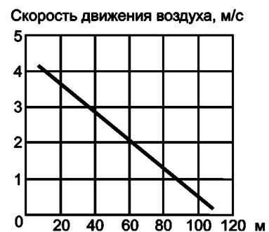
Рисунок 5 — Расстояние между первой и второй туманообразующими завесами (длина участка связывания) в зависимости от скорости движения воздуха в выработке
