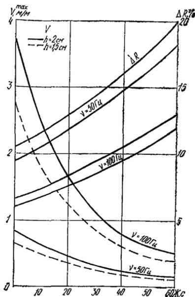
Рис. 1. Расчетные зависимости скорости формования и потерь прочности из-за недоуплотнения от жесткости бетонной смеси и частоты вибрирования
