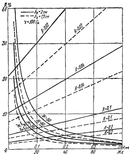
Рис. 2. Расчетные потери прочности бетона из-за недоуплотнения при частоте вибрирования 100 Гц в зависимости от жесткости смеси и амплитуды колебаний
