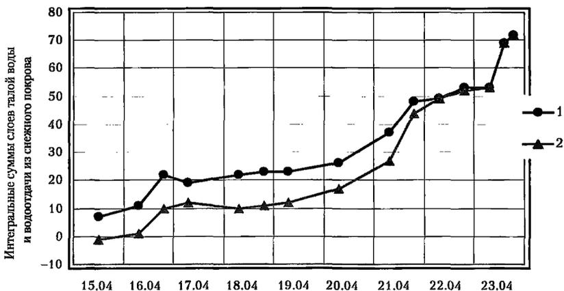
**Рисунок 4** — Совмещенный график интегральных сумм слоев талой воды  $\Sigma t$ (1) и водоотдачи  $\Sigma M$ (2) из снежного покрова за период снеготаяния с 15 по 23 апреля 2002 г. по данным метеостанции Валдай
