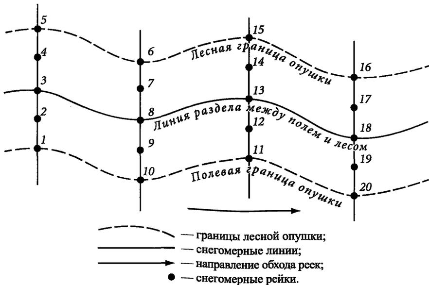
**Рисунок 3** — Схема расположения снегомерных рек на лесной опушке
