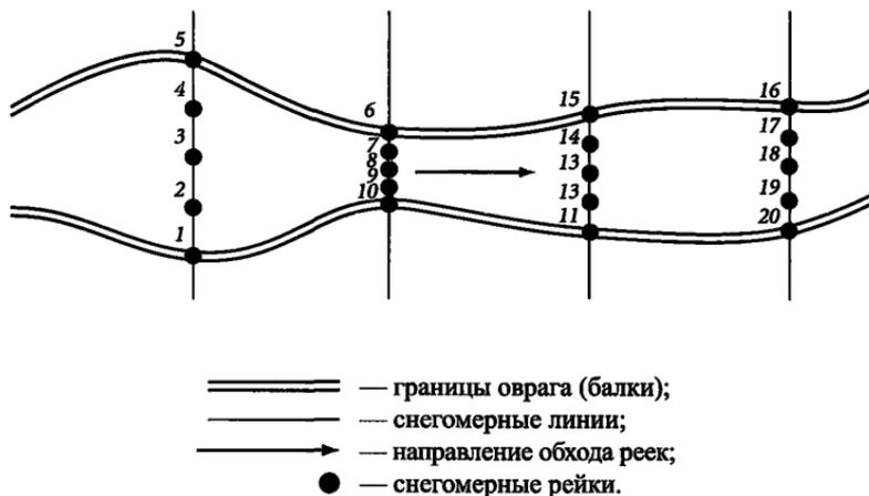
Рисунок 2 — Схема расположения снегомерных реек в овраге (балке)
