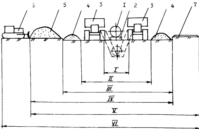
Рис.4. Полосы отвода (I-VI) для двухроторного двухотвального экскаватора-трубозаглубителя:
