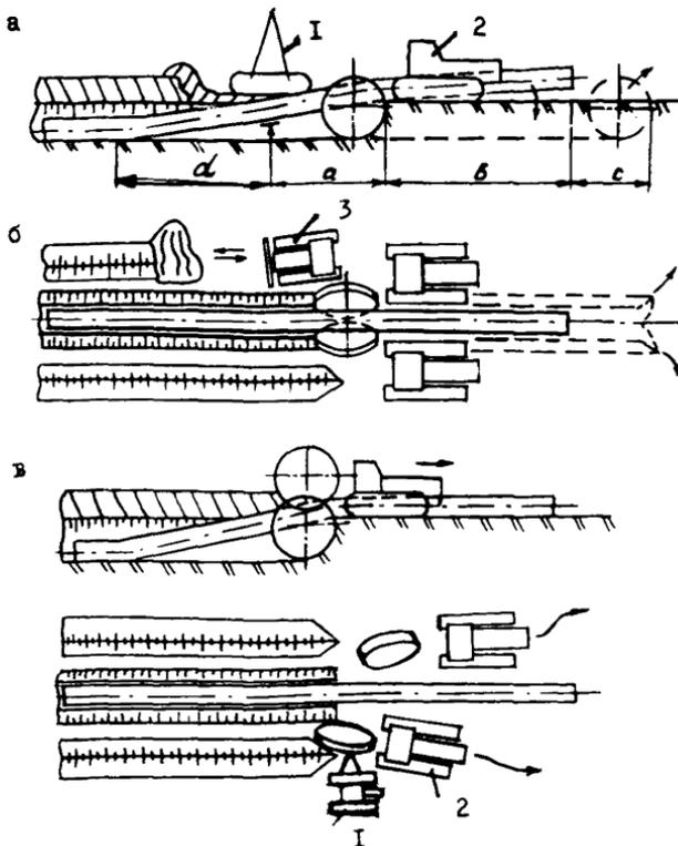
Рис.6. Выглубление двухторного экскаватора-трубозаглубителя:
