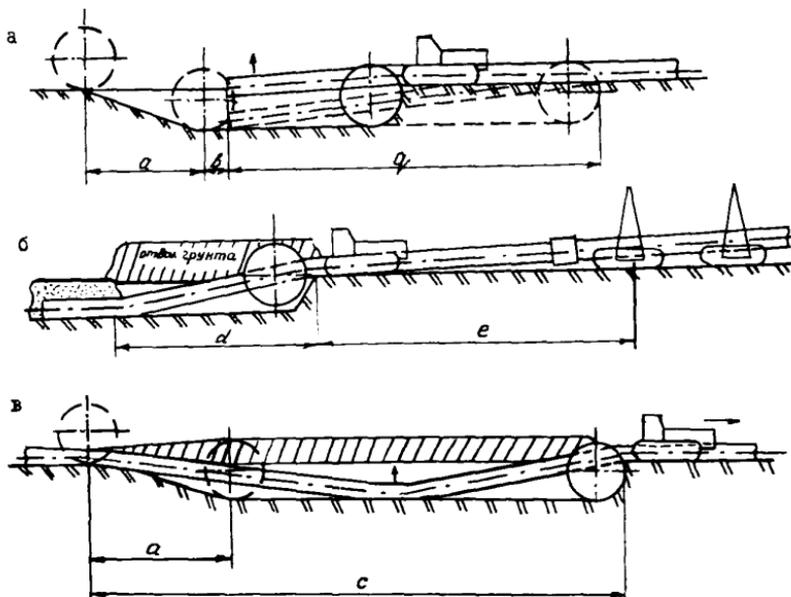
Рис.5. Заглубление экскаватора-трубозаглубителя:
