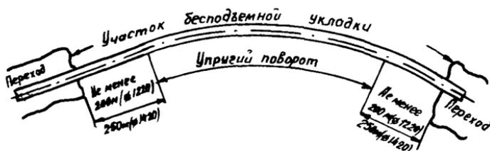
Рис.2. Переходы на упругом повороте трассы трубопровода
