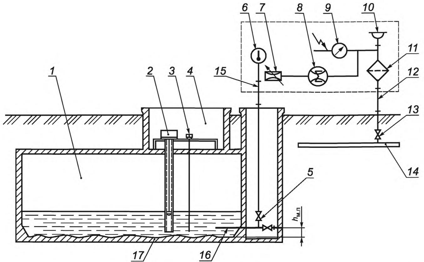
1 — резервуар; 2 — уровнемер; 3, 6 — измерители температуры; 4 — колодец; 5, 13 — задвижки; 7 — дроссель; 8 — счетчик жидкости; 9 — измеритель давления (манометр); 10 — воздухоотделитель (вантуз); 11 — фильтр; 12, 15 — рукава; 14 — технологический трубопровод; 16 — приемно-раздаточный патрубок; 17 — днище резервуара;  $h_{м.п}$  — высота «мертвой» полости
