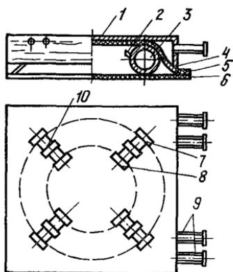
Рис. 47. Виброизолированная рабочая площадка на пневматической подушке
