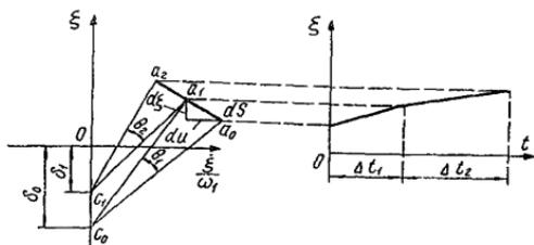
Рис. 54. К построению интегральной кривой на плоскости  $\xi - \xi/\omega_1$  и кривой  $\xi(t)$
