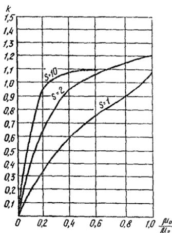
Рис.35. Графики зависимости коэффициента  $k$  от отношения  $\mu_0/\mu_2$
