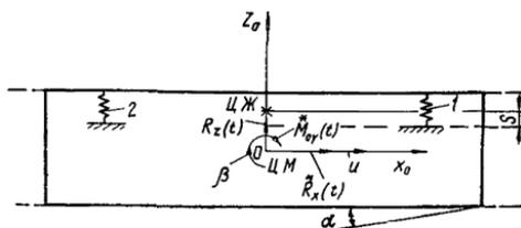
Рис. 55. Расчетная схема вибрационного грохота
