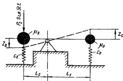
Рис. 29. Рычажная схема виброизоляции
