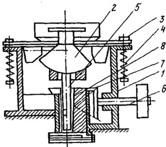
Рис.6. Схема конусной дробилки
