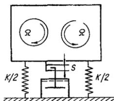
Рис.42. Система с вязким демпфером, включающимся через люфт
