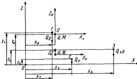
Рис.10. Схема для определения координат центра масс установки
