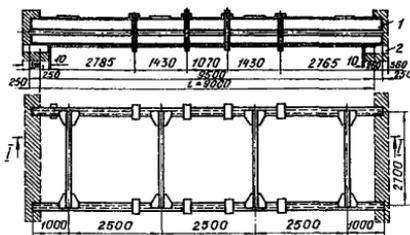
Рис. 57. Общий вид разгрузочной балки
