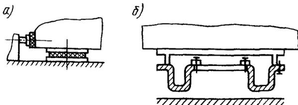
Рис.19. Малогабаритные виброизоляторы
