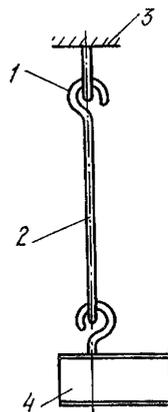
В качестве виброизоляторов могут быть использованы также стальные стержни с шарнирным закреплением их концов (рис. 9).
