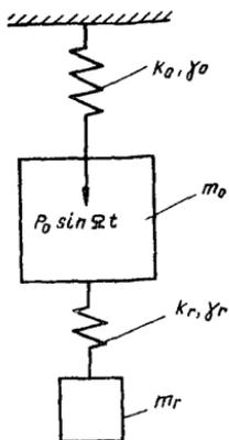
Рис.46. Расчетная схема установки с виброгасителем
