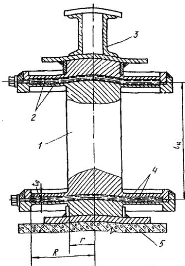
3.32. Несущая способность виброизолятора с гидр шарнирами определяется величиной напряжений в кольцевой пластине [ 6, 22 ]
