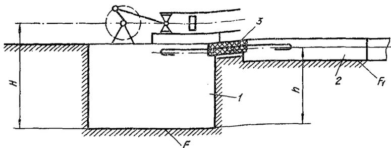
Рис.45. Схема фундамента с шарнирно присоединенной к нему массивной плитой
