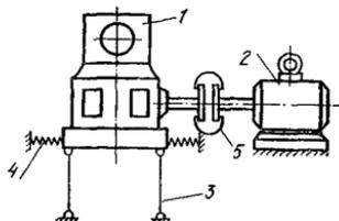
Рис.17. Опорная безрамная схема виброизоляции с жесткой установкой электродвигателя и компенсирующей муфтой привода
