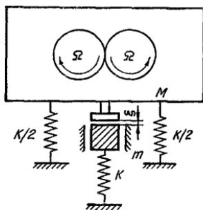
Рис.43. Схема виброизолированной машины с ударным гасителем колебаний
