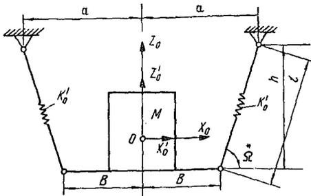
Рис. 12. Наклонный подвес
