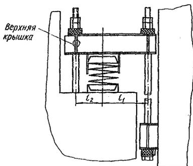
Рис.51. Рычажный низкочастотный виброизолятор
