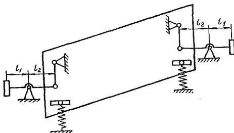
Рис. 38. Схема виброизолированного грохота с рычажными корректорами колебаний
