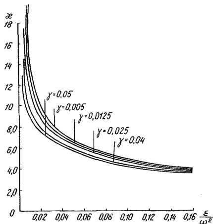
Рис. 3. Зависимость коэффициента  $\mathcal{X}$  от отношения  $\frac{\xi}{\omega^2}$
