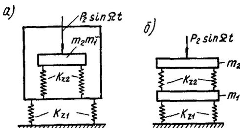
Рис. 49. Двухзвенные схемы виброизоляции
