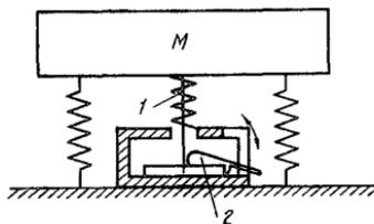
Рис. 41. Виброизолированная система с эксцентриковым механизмом
