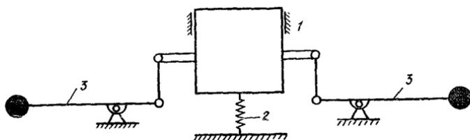
Рис.36. Схема виброизоляции с внешним расположением рычажных корректоров
