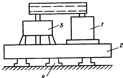
Рис. 28. Виброизолированная молотковая дробилка
