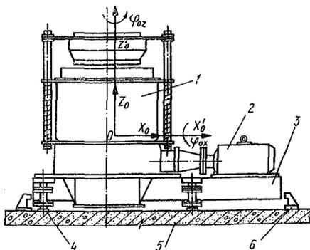
Рис.13. Опорная схема виброизоляции конусной дробилки
