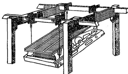
Рис. 22. Подвеска грохотов к самостоятельным сборным железобетонным конструкциям
