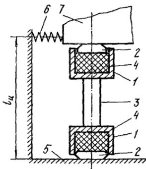
Рис.16. Астатический виброизолятор
