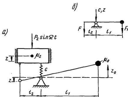
Рис.32. Рычажная схема виброизоляции с корректором
