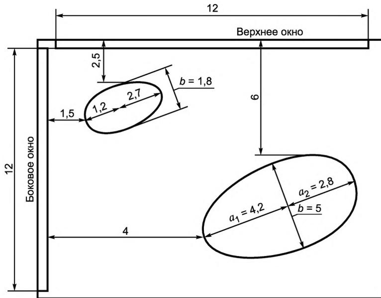
Рисунок В.1 — Фантом с тканеимитирующими яйцеобразными мишенями
