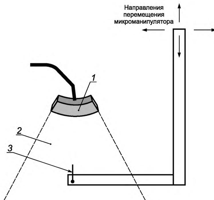
1 — преобразователь; 2 — обзорное поле; 3 — линейная мишень
