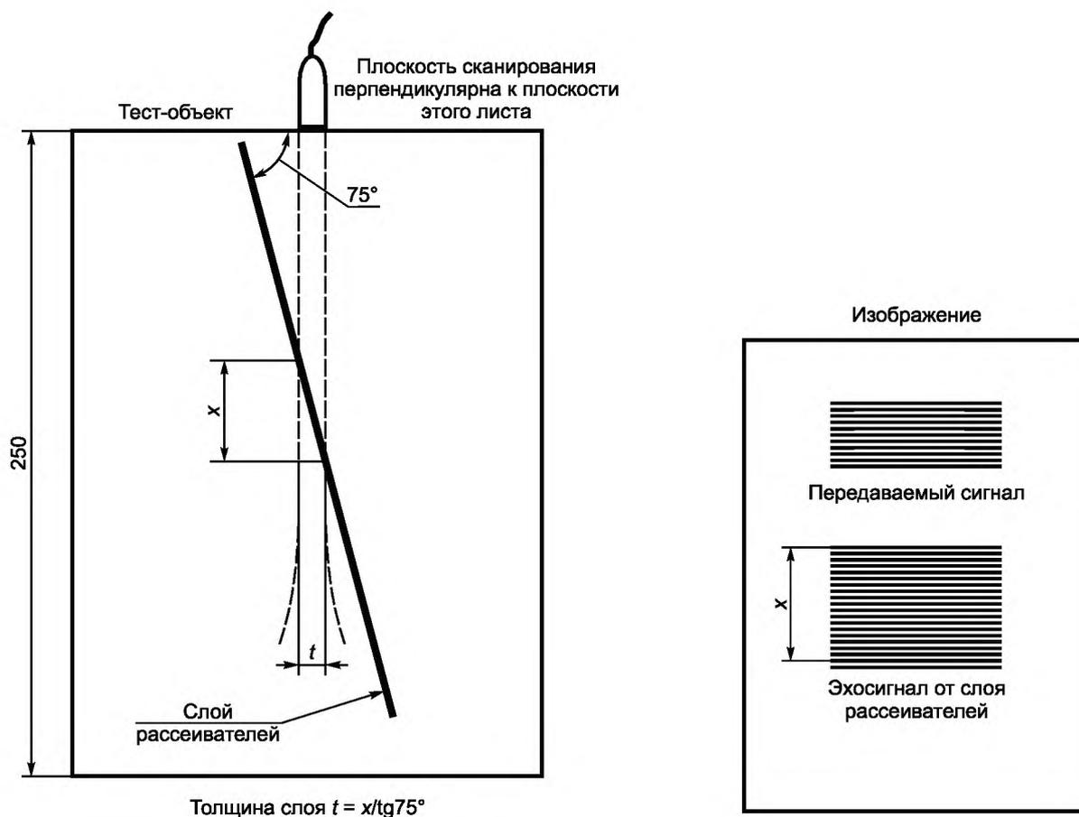
Рисунок С.5 — Измерения и расчет толщины слоя рассеивателей
