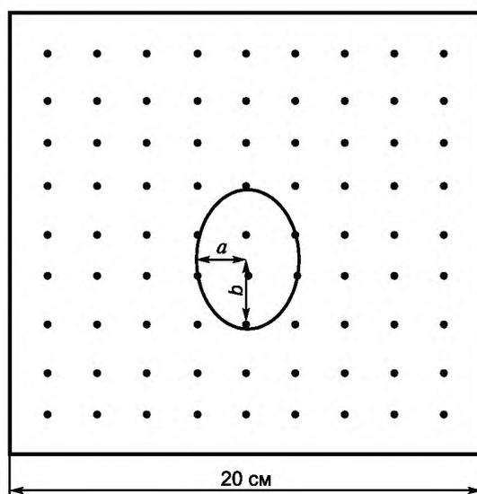
П р и м е ч а н и е — На фантоме выделено изображение эллипса, используемого для измерений длины кривых линий, например, периметра.
