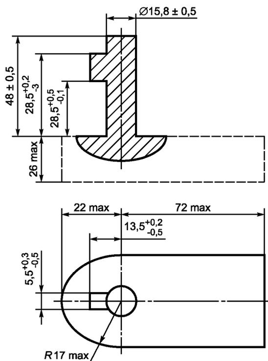
Примечание — Бородак ключа должен по всему контуру свободно входить в гнездо и обеспечивать запирание фиксирующего устройства.
