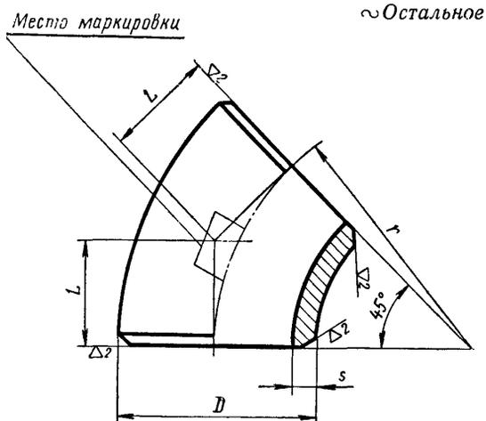
Пример обозначения отвода 45°  $D=219$  мм,  $s=16$  мм:
