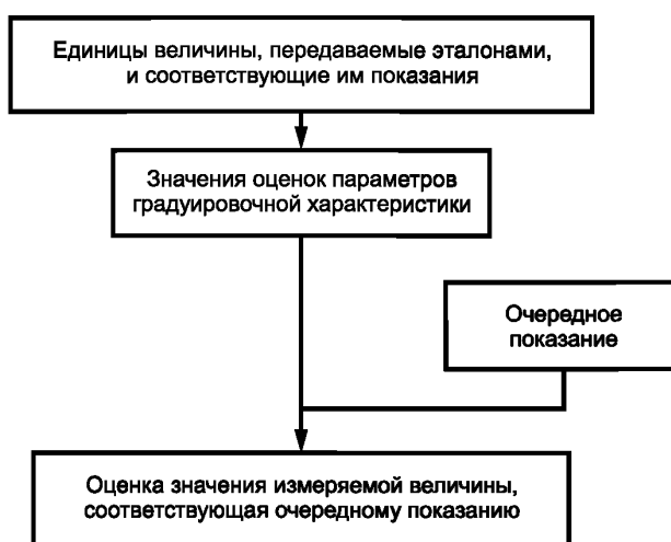
Рисунок 6 — Модель двухступенчатого измерения, включающего построение градуировочной характеристики и ее применение к показаниям измерительной системы
