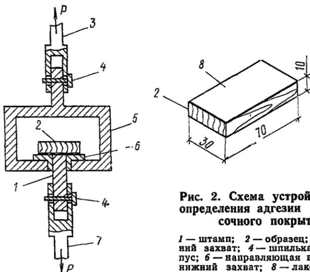
Рис. 2. Схема устройства для определения адгезии лакокрасочного покрытия
