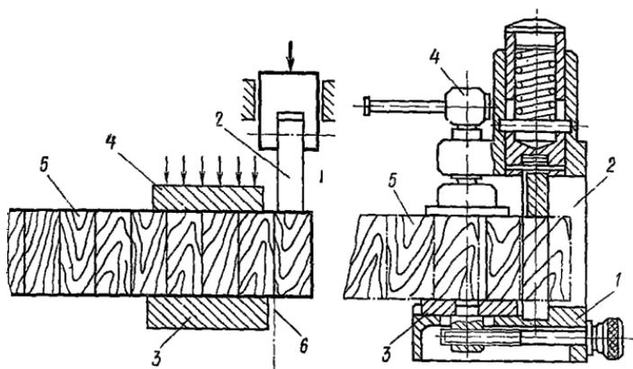
Рис. 3. Схема приспособления для испытаний на послойное скалывание
