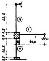
1. Вычисляют  $\frac{1}{E}$  кратные значения погонных жесткостей стержней 1, 3, 4.
