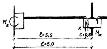
4. Производят распределение моментов, действующих в узлах средних стоек (рис. 17е).
