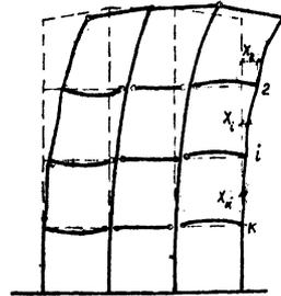
$X_1, X_2, X_i, X_k$  — горизонтальные перемещения — точек 1, 2, i, k (рис. 10) от внешней нагрузки.
