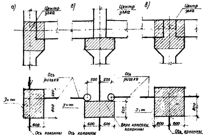
Рис. 4 Узлы и их расчетные схемы
