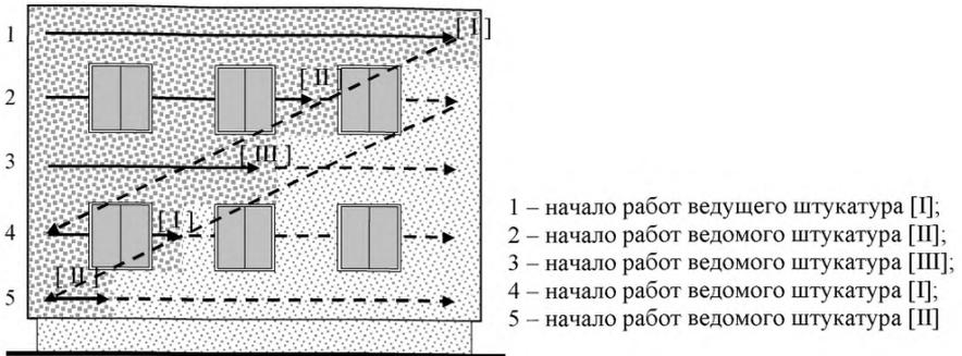
Рисунок 7 – Горизонтально-нисходящая схема устройства декоративно-защитного финишного слоя
