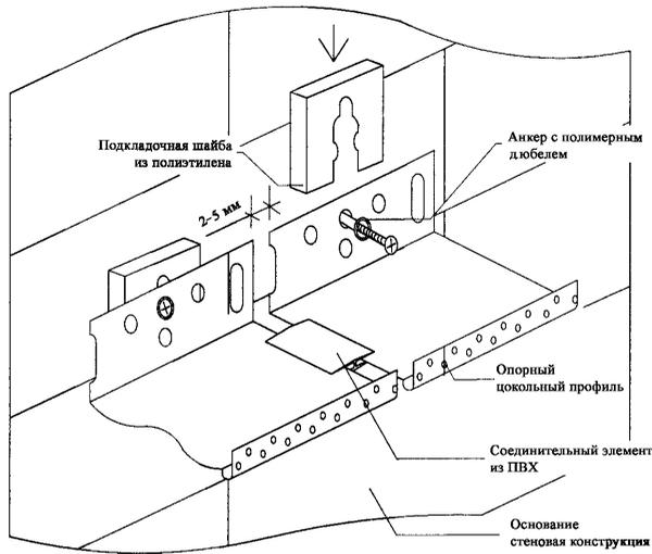
Рисунок 1 – Схема монтажа опорного (цокольного) профиля
