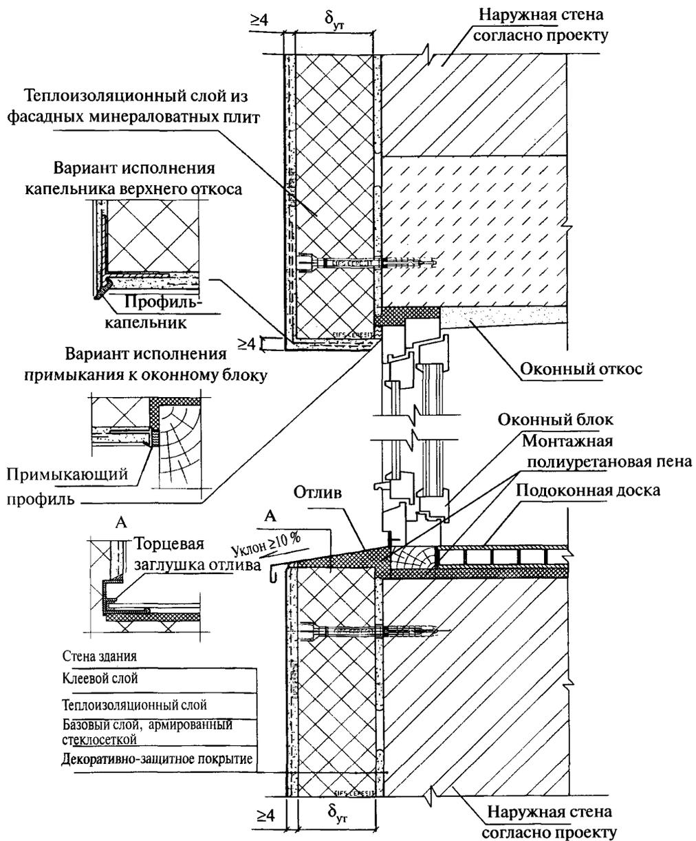
Рисунок 5 – Узел примыкания СФТК к оконному блоку (пример)
