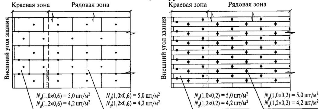
Рисунок 4 – Схемы установки тарельчатых дюбелей
