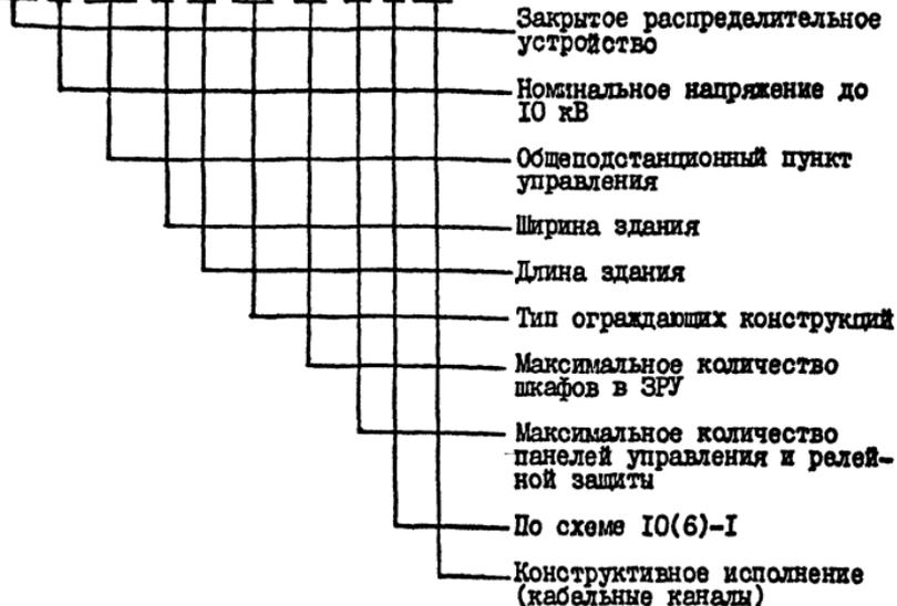
В проекте принят следующий принцип построения нумерации шкафов КРУ: номер любого шкафа, независимо от его назначения, состоит из двух составных частей - номера секции (первая цифра) и порядкового номера шкафа данной секции (последующие цифры), например:
