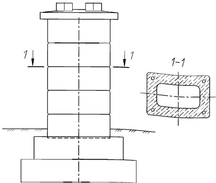
Рисунок 8.3 – Опоры с пустотелыми горизонтально располагаемыми блоками
