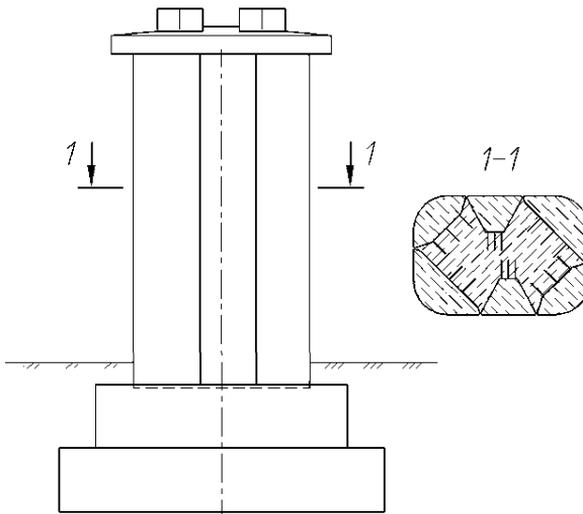
Рисунок 8.2 – Опоры с вертикальными железобетонными контурными блоками
