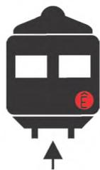
— красный огонь фонаря у буферного бруса с правой стороны (обозначение тепловоза сзади, находящегося в хвосте поезда, а также следующего без вагонов)
