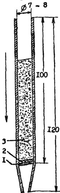
Рис. Концентрационная трубка
