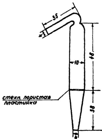
Рис. 1. Стеклянная трубка с пористой пластинкой для отбора проб воздуха
