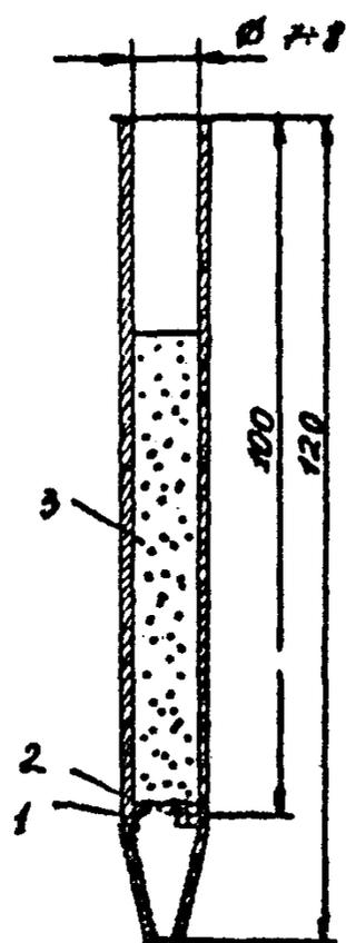
Рис.3. Концентрационная трубка
