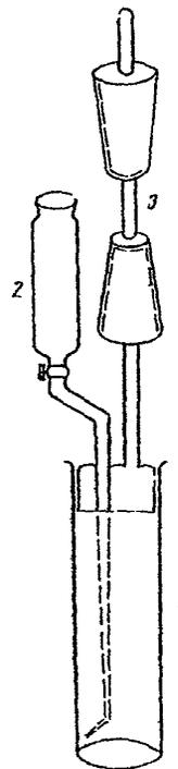
Рис. 4. Прибор для получения мышьяковистого водорода:
