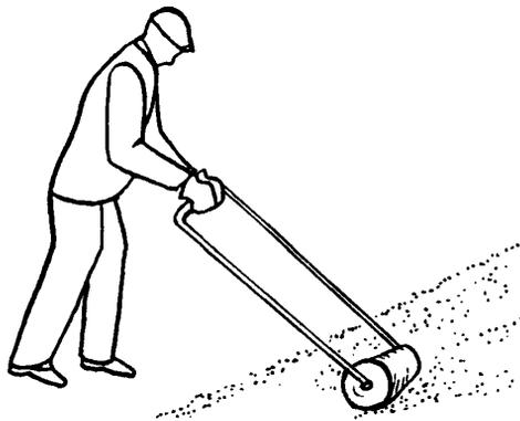
Кровельщики К<sub>1</sub> и К<sub>4</sub> разравнивают гравий деревянными гребками по мастике, а кровельщик К<sub>5</sub> прикатывает выровненный слой гравия катком
