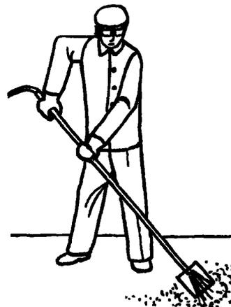
2 ОГРУНТОВКА ОСНОВАНИЯ; 5 мин; К<sub>1</sub>, К<sub>2</sub>; агрегат ГУ-2, компрессор, шланги, удочка
