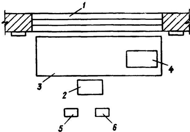
1 - оконный проем; 2 - ящик с известковым раствором; 3 - столик-подмости; 4 - ящик для приготовления раствора; 5 - ящик с цементом; 6 - ящик с гипсом
