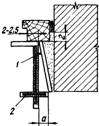
Угол рассвета (1) определяется угольником с передвижной пластиной (2). Штукатур приставляет угольник к оконной коробке и, двигая пластину по большой линейке с делениями, закрепляет ее на уровне стены. Исходя из угла рассвета по делениям на передвижной пластине угольника, штукатур отмечает величину рассвета (a)
