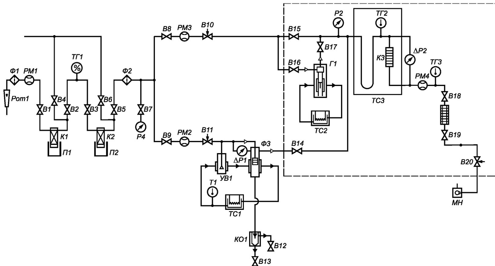
Рисунок 1 — Схема аппаратурно-технологической испытательной установки
