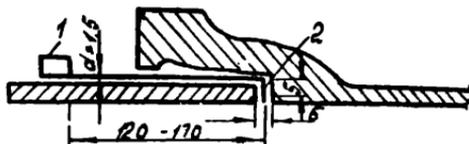
Рис. 5. Проволочный крючок для замера величины зазора между торцами стыкуемых труб
