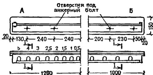
Полочки крепят одна над другой, каждую пятью анкерными болтами, замоноличенными в стену. Выбор типа и число полочек определяют исходя из заданного числа гантелей разной массы.
