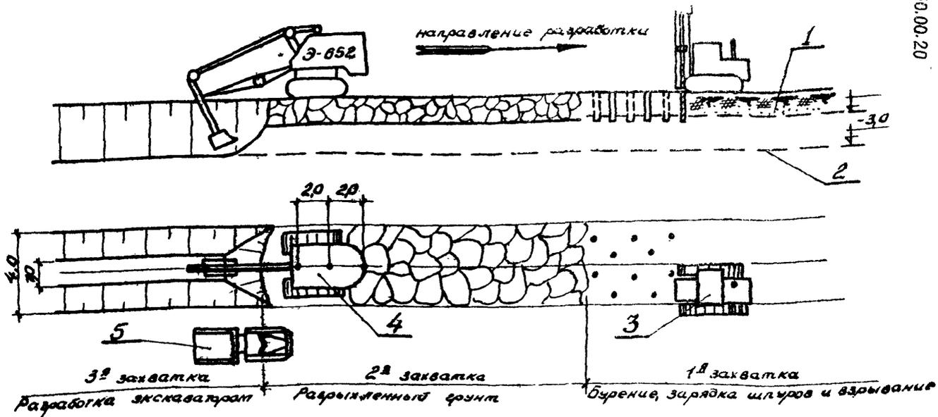
рис. 3 Схема разработки траншеи при рылении мерзлого грунта буровзрывным способом
