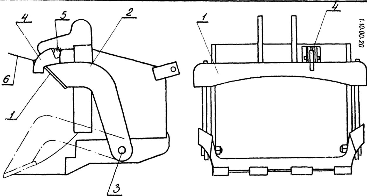
Рис. 2 Струг для зачистки дна траншеи экскаватором.
