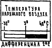
Устройство терморегулирующее SK1 Диаграмма работы контактов
