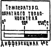
Устройство терморегулирующее SK2 Диаграмма работы контактов
