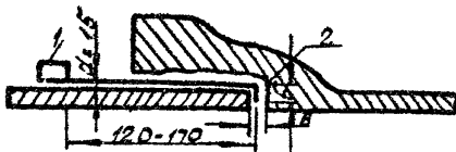
Рис. 5 Проволочный крючок для замера величины зазора между торцами стыкуемых труб
