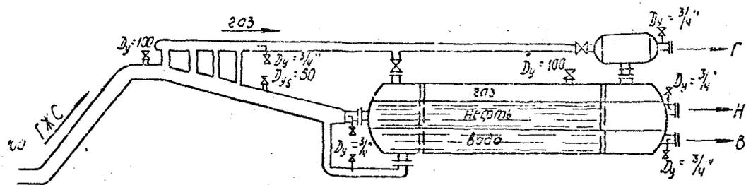
Рис. 3. Принципиальная схема сепарационной установки при работе по совмещенной технологии сепарации газа и предварительного сброса воды,
