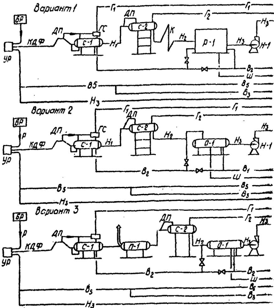
Рис. 4. Технологические схемы предварительного разделения продукции скважин
