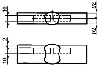
Рисунок 2 — Расположение образцов для испытаний на ударный изгиб
