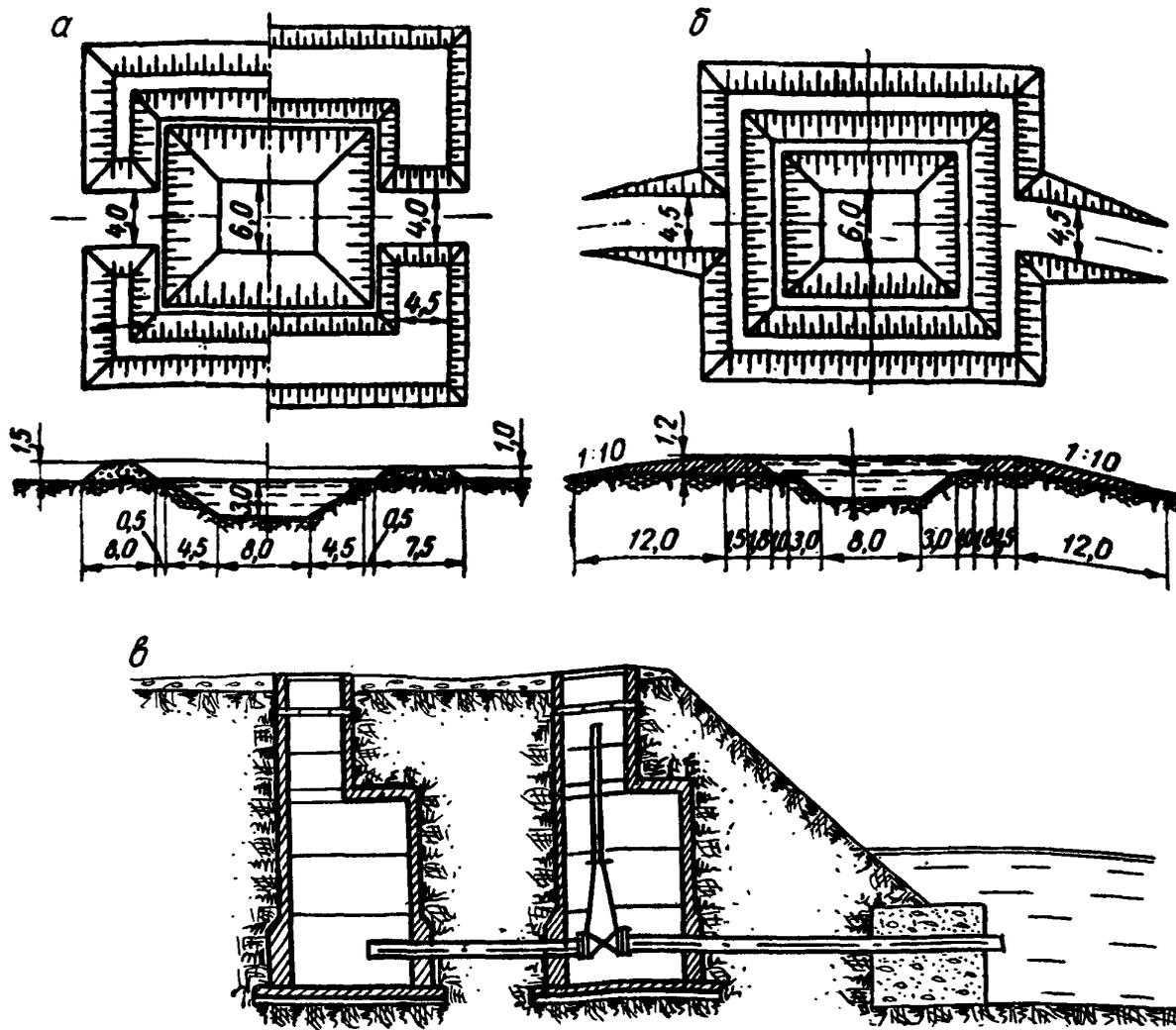
Рис. 6.6. Противопожарные водоемы:
