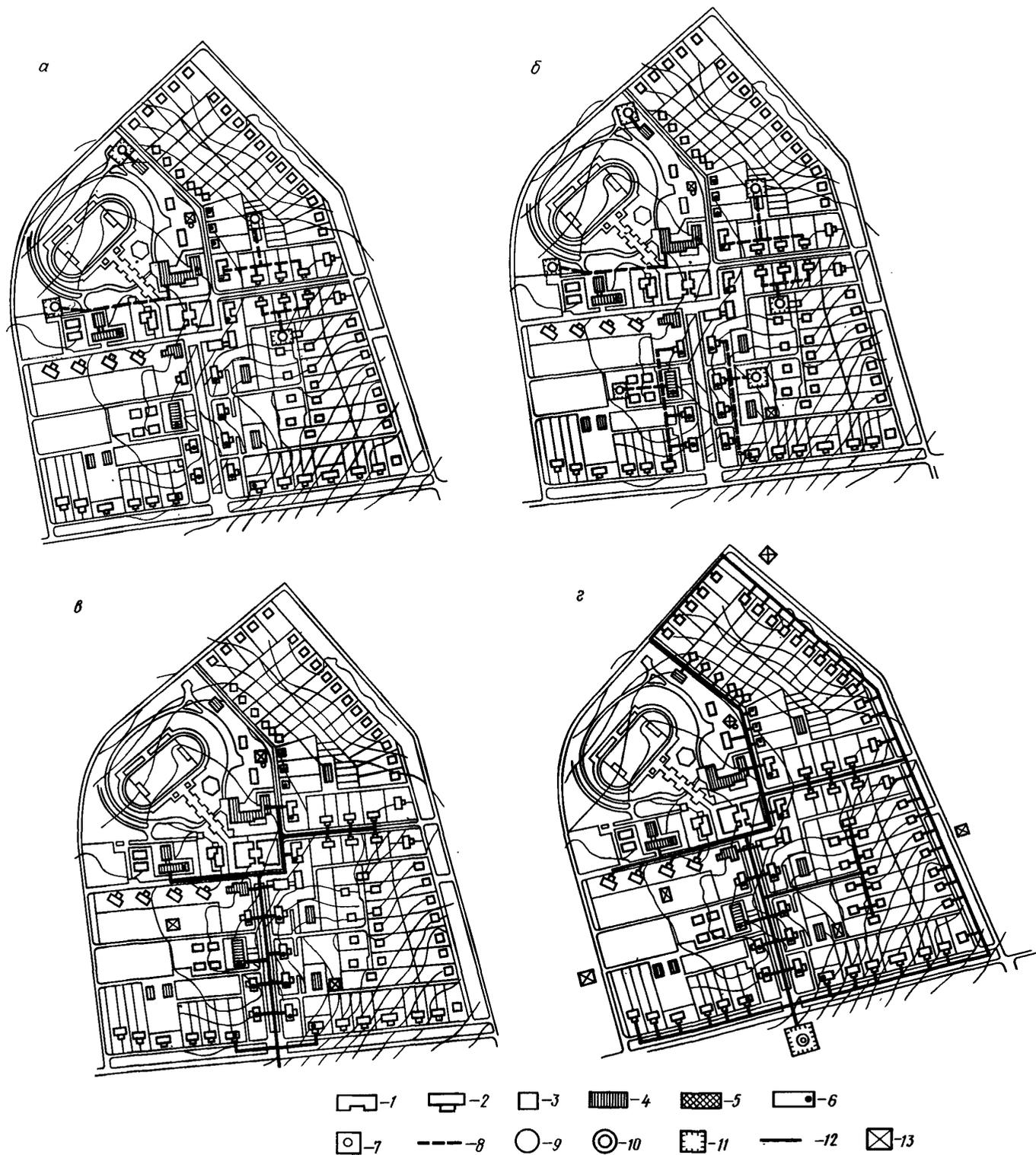
Рис. 10.13. Схема водоснабжения поселка с населением 800 чел. (постепенное развитие систем водоснабжения):
