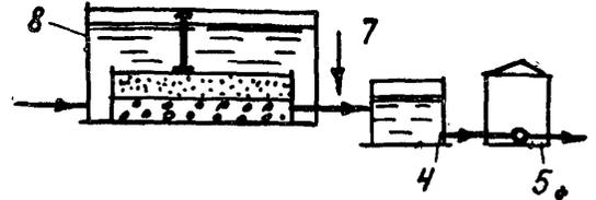
Примечание. Состав основных технологических сооружений станции осветления и обезжелезивания воды: 1 - смеситель; 2 - камера хлопьеобразования с вертикальным отстойником; 3 - скорые фильтры; 4 - резервуар чистой воды; 5 - насосная станция II подъема; 6 - подача реагентов; 7 - подача хлора для обеззараживания воды; 8 - медленные фильтры.
