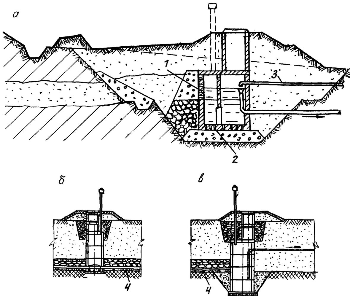
Рис. 6.3. Каптажные сооружения:
