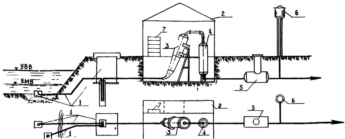
Рис. 10.6. Схема движения воды по сооружениям (вариант У):
