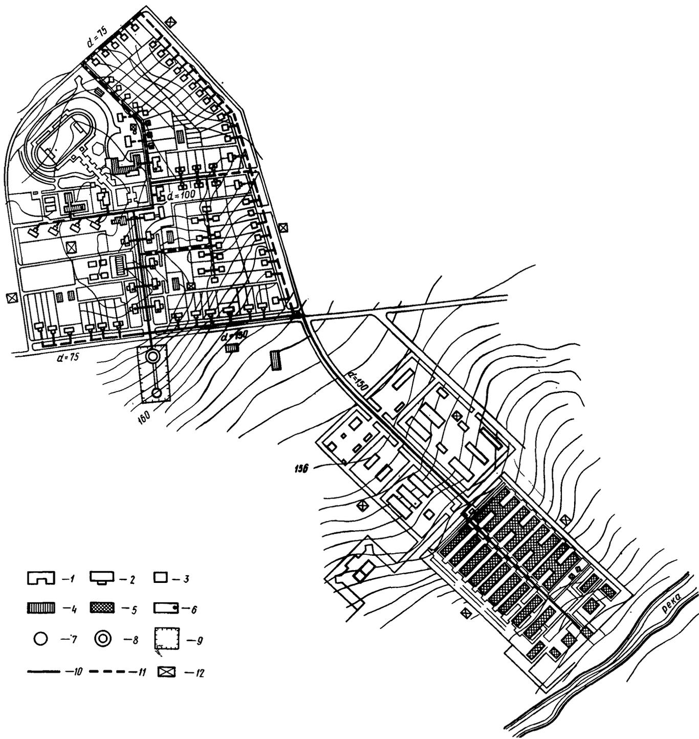
Рис. 10.12. Схема водоснабжения поселка с населением 800 чел. (вариант Ш):
