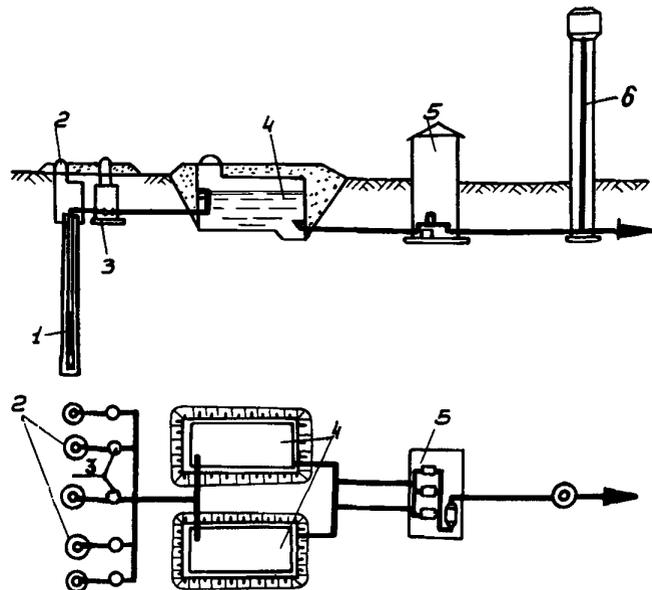
Рис. 10.15. Схема движения воды по сооружениям (вариант П):
