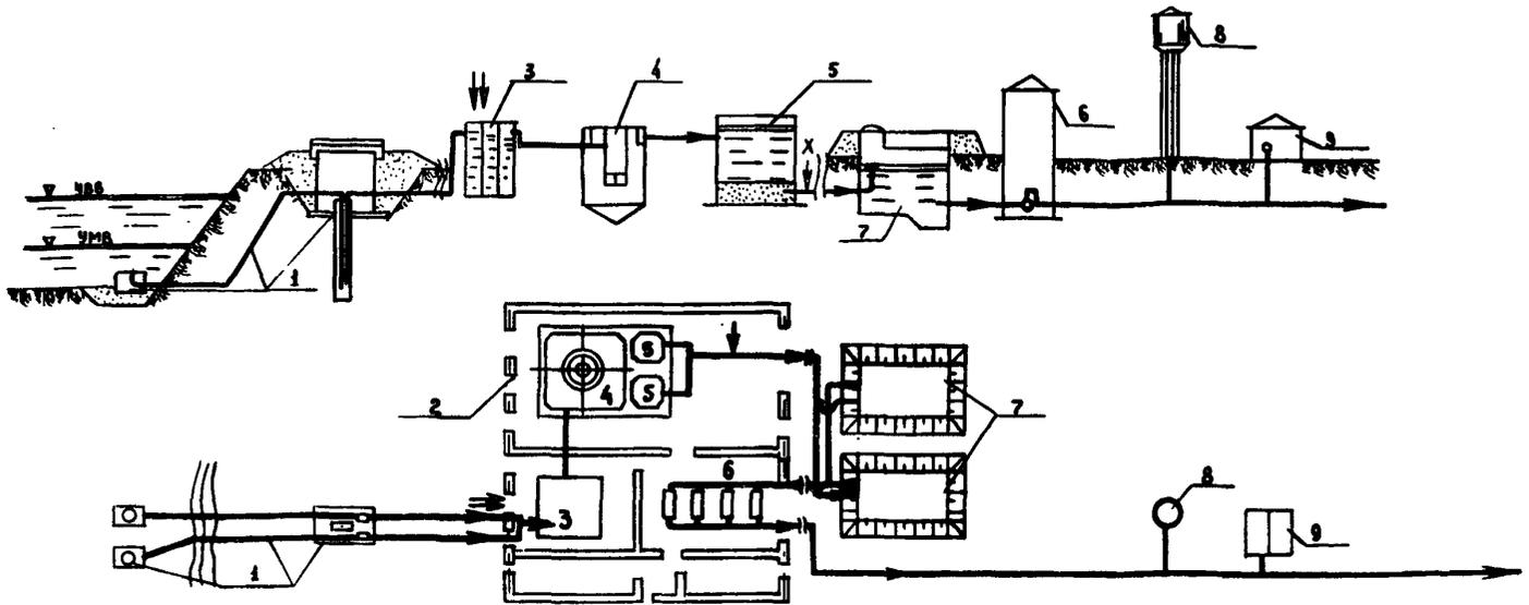
Рис. 10.9. Схема движения воды по сооружениям (вариант Ya):
