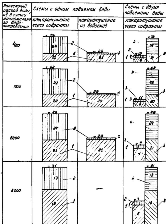
Рис. 6.7. Регулирующие и запасные объемы воды по данным расчетов для типичных суточных расходов, % расчетного расхода воды в сутки максимального водопотребления:
