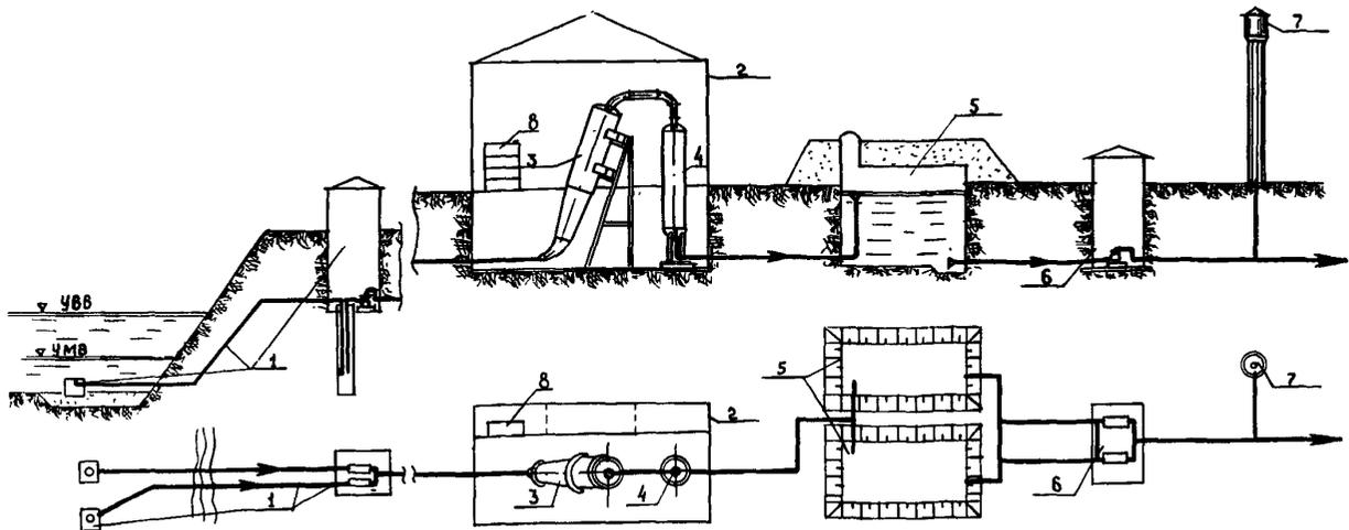
Рис. 10.18. Схема движения воды по сооружениям (вариант 1):
