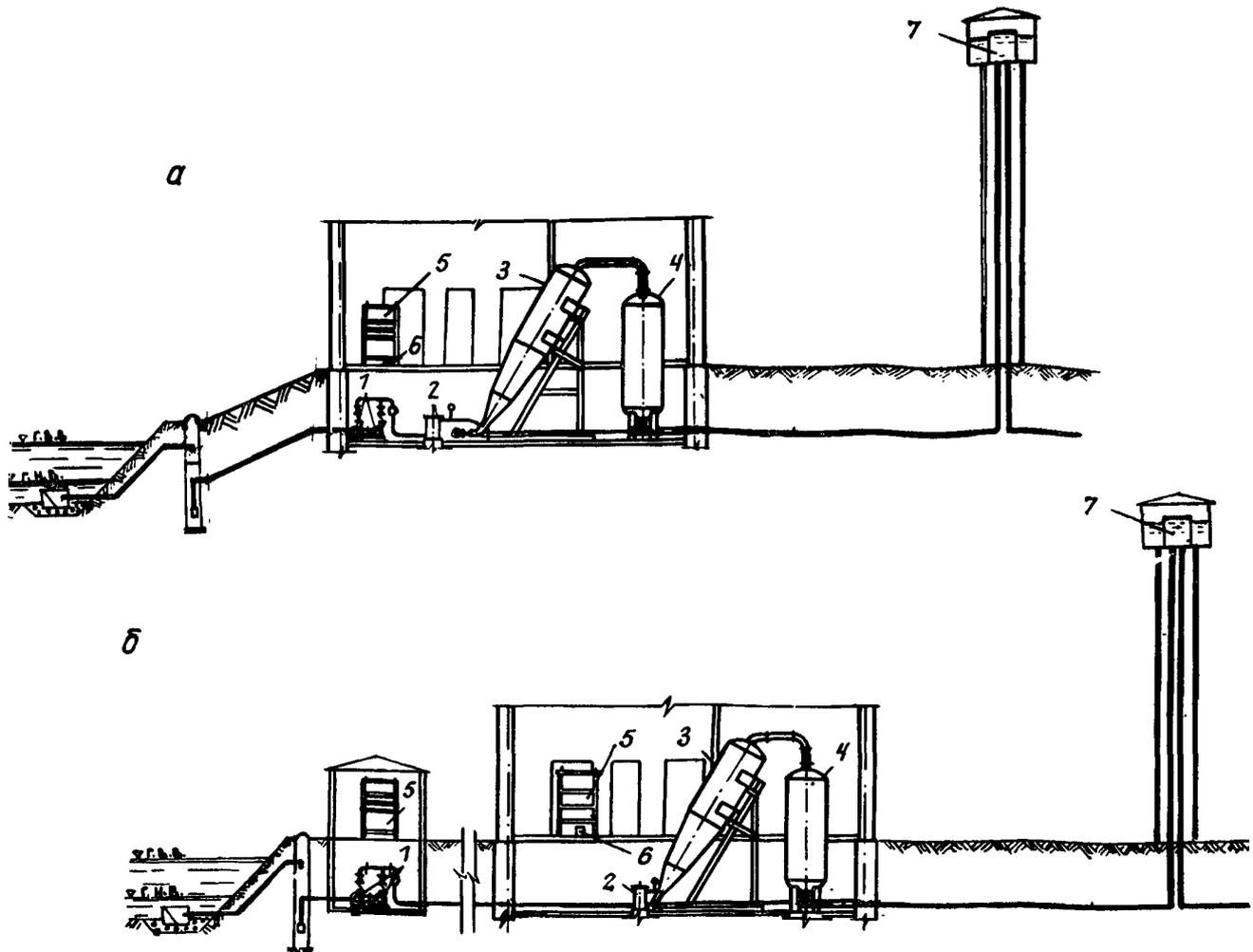
Рис. 6.5. Схема водоочистой установки "Струя":
