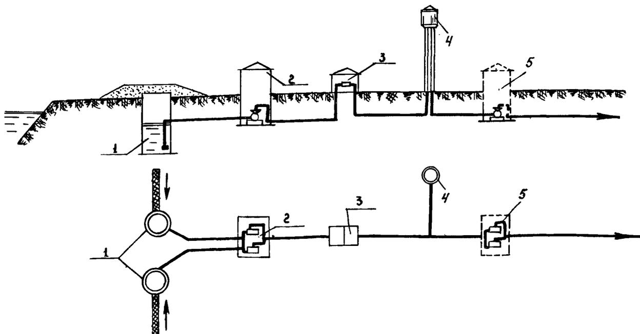
Рис. 10.8. Схема движения воды по сооружениям (вариант УШ):
