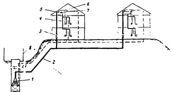
Рис. 7.2. Система децентрализованного водоснабжения:
