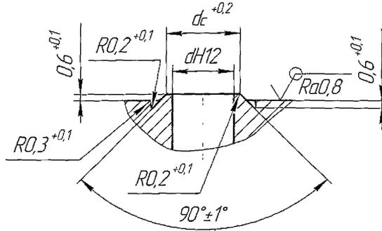
Рисунок 5 – Конструкция сѐдел для уплотняемого диаметра от 0,5 мм до 6,0 мм включительно
