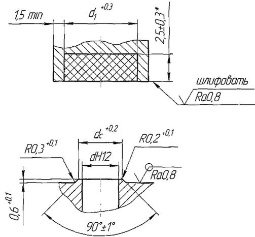
Рисунок 1 – Тип уплотнения I размером уплотнения от 0,5 мм до 6,0 мм включительно
