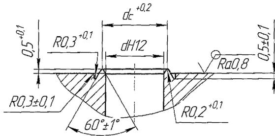
Рисунок 6 - Конструкция сѐдел для уплотняемого диаметра от 0,5 мм до 6,0 мм включительно
