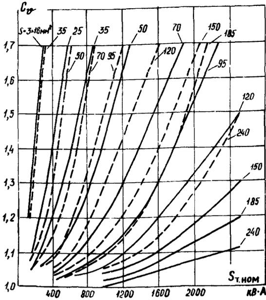
Рис.4. Кривые зависимости коэффициента увеличения активного сопротивления кабелей с медными жилами ( $C_0$ ) при нагревании их током трехфазного КЗ от мощности трансформатора:
