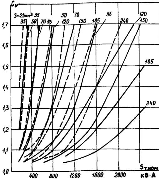
Рис.2. Кривые зависимости коэффициента увеличения активного сопротивления кабелей с алюминиевыми жилами ( $C_p$ ) при нагревании их током трехфазного КЗ от мощности трансформатора:
