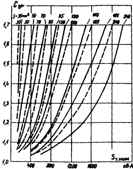
Рис.5. Кривые зависимости коэффициента увеличения активного сопротивления кабелей с медными жилами ( $C_\phi$ ) при нагревании их током трехфазного КЗ от мощности трансформатора:
