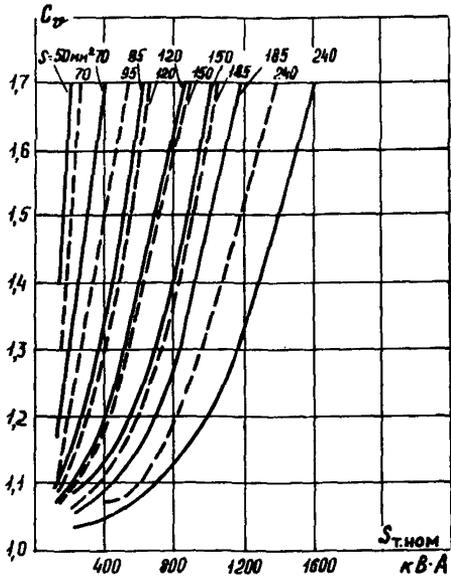
Рис.3. Кривые зависимости коэффициента увеличения активного сопротивления кабелей с алюминиевыми жилами ( $C_p$ ) при нагревании их током трехфазного КЗ от мощности трансформаторов: —  $t_{откл} = 0,7$  с; ---  $t_{откл} = 1,0$  с
