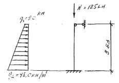
Расчетная нагрузка на днище
