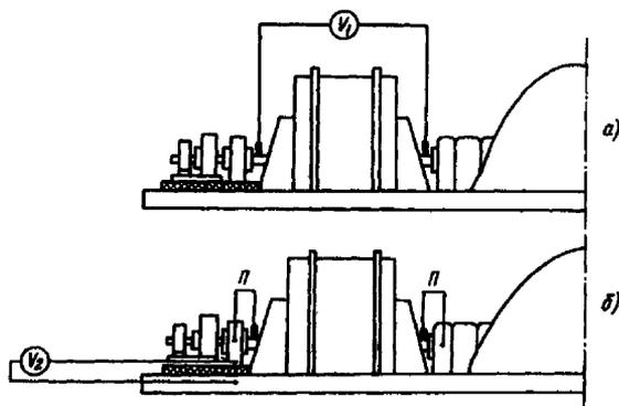
а – на концах вала; б – между изолированной опорой подшипника и фундаментной плитой; П – перемычка для шунтирования масляной пленки
