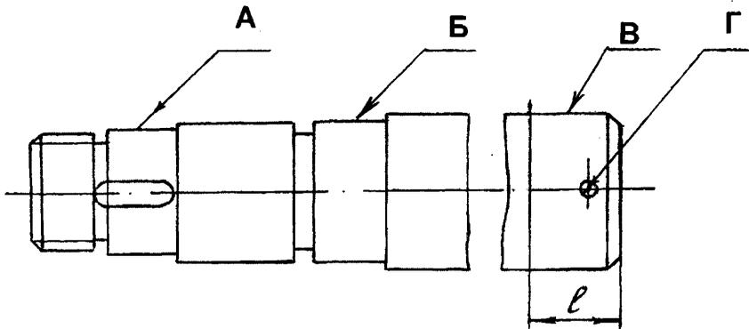
Рисунок 47 – Вал (поз. 3 см. рисунок 44)
