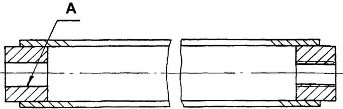
Рисунок 67 – Стяжка (поз. 8 см. рисунок 60)
