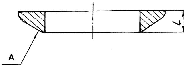
Рисунок 30 – Шайба (поз. 2 см. рисунок 28)
