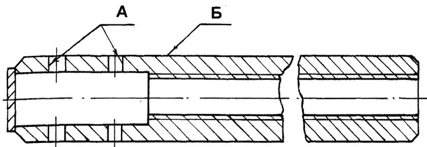
Рисунок 65 – Втулка (поз. 5 см. рисунок 60)
