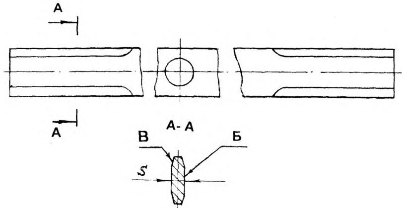
Рисунок 77 – Нож (поз. 1 см. рисунок 75)
