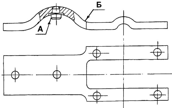
Рисунок 18 – Полухомут (поз. 1 см. рисунок 17)
