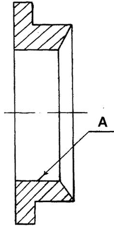
Рисунок 50 – Втулка нажимная (поз. 6 см. рисунок 44)
