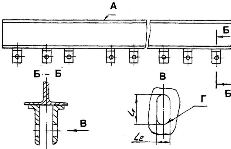
Рисунок 4– Балка подвеса (поз. 3 рисунка 2)
