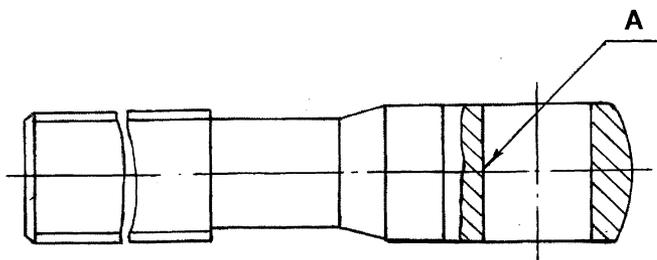
Рисунок 15 – Винт (поз. 2 см. рисунок 13)
