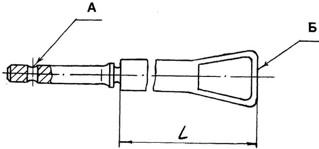
Рисунок 24 – Наковальня (поз. 2 см. рисунок 22)
