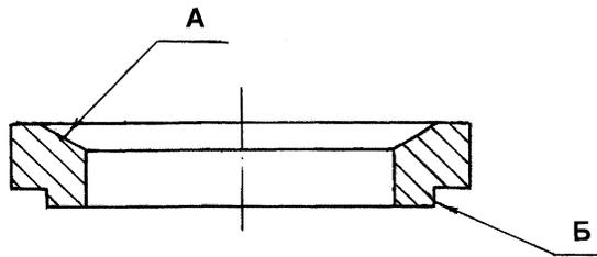
Рисунок 31 – Шайба (поз. 3 см. рисунок 28)
