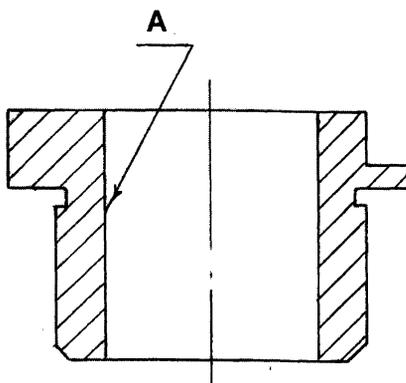
Рисунок 14 – Втулка (поз. 1 см. рисунок 13)
