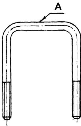
Рисунок 70– Хомут (поз. 1 см. рисунок 69)
