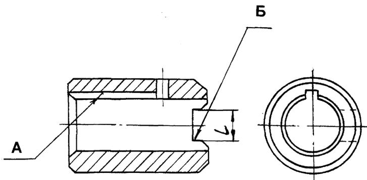
Рисунок 45 – Полумуфта (поз. 1 см. рисунок 44)
