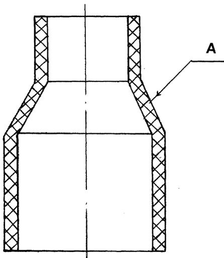
Рисунок 33 – Изолятор (поз. 4 см. рисунок 28)
