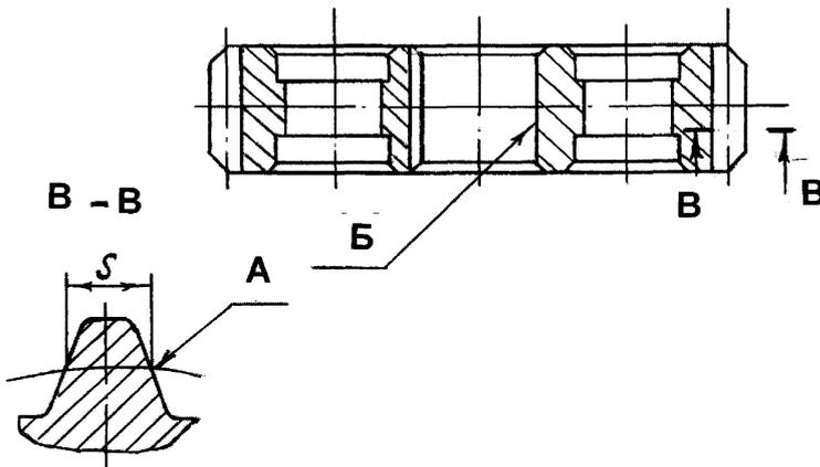
Рисунок 46 – Колесо зубчатое (поз. 2 см. рисунок 44)
