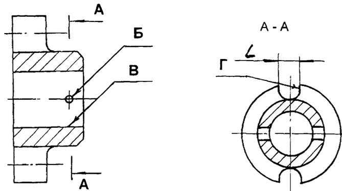
Рисунок 12 – Полумуфта (поз. 8 рисунка 6)
