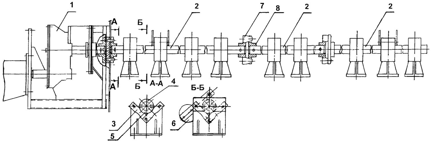
1 – привод; 2 – вал; 3 – пластина; 4, 5 – хомут; 6 – молоток; 7, 8 – полумфта
