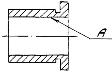
Рисунок 20 – Втулка (поз. 3 см. рисунок 17)
