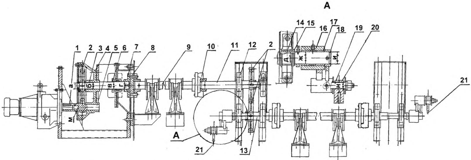
1 – полумфта; 2 – колесо зубчатое; 3 – вал; 4 – корпус; 5 – шестерня; 6 – втулка нажимная; 7 – полумфта; 8 – крестовина;
