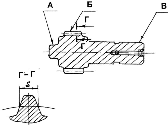
Рисунок 49 – Шестерня (поз. 5 см. рисунок 44)
