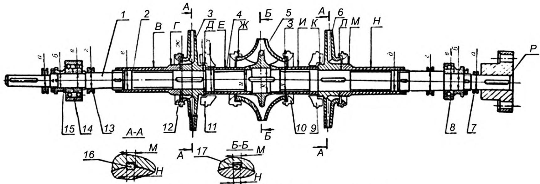
Рисунок 4 – Ротор насосов Кс125–140 и КсД230–115
