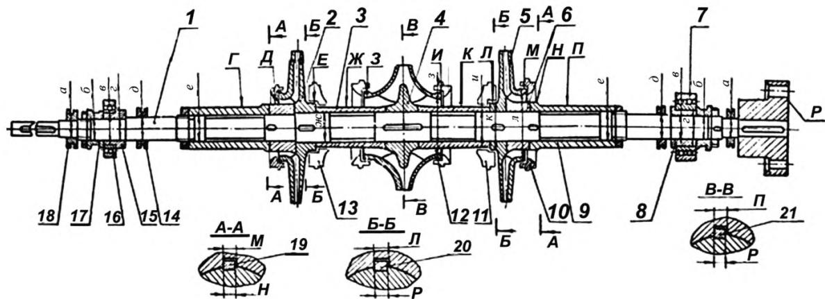
Рисунок 3 – Ротор насоса Кс125–55
