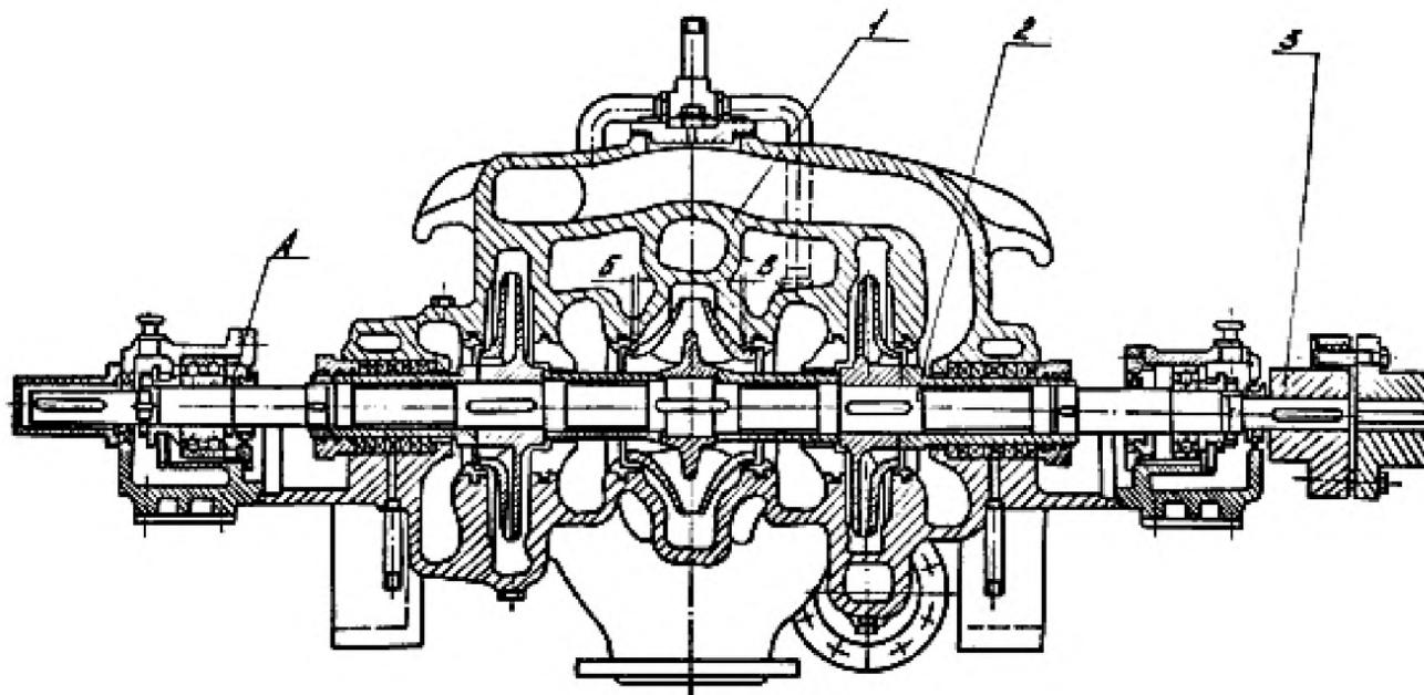
1 – корпус; 2 – ротор; 3 – муфта упругая
