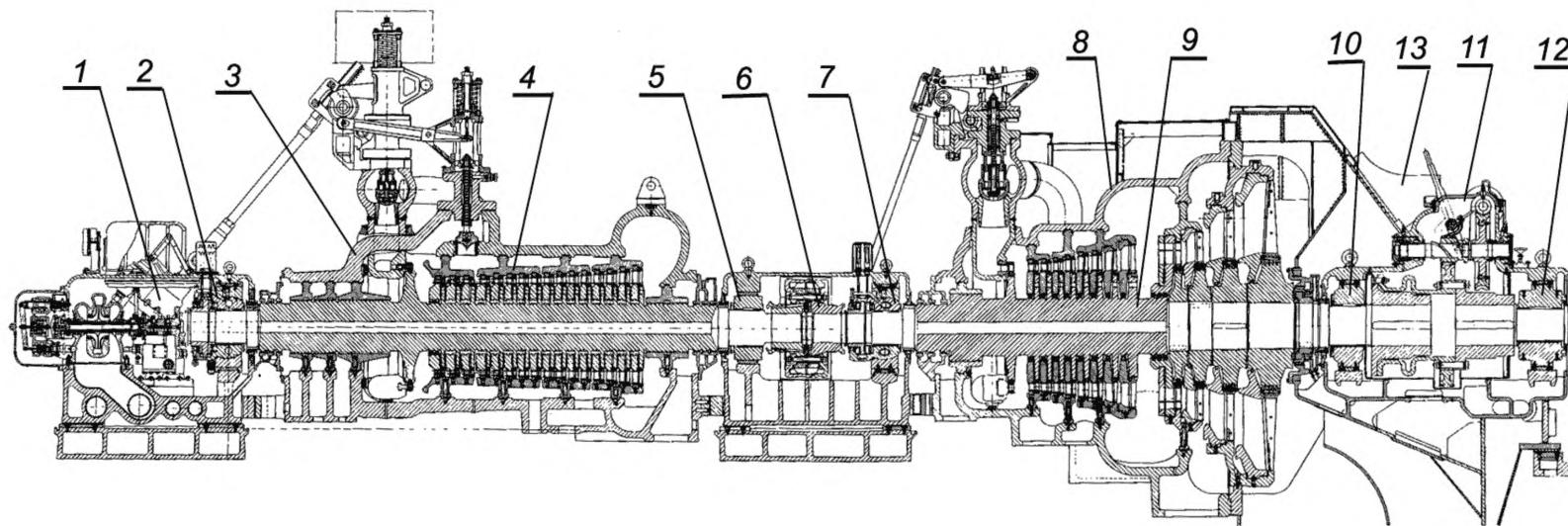
1. Передний подшипник; 2. Вкладыш опорно-упорного подшипника № 1; 3. ЦВД; 4. РВД;
