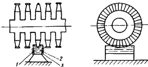
1 - свинцовая ванна; 2 - термоэлектрический термометр; 3 - индуктор
