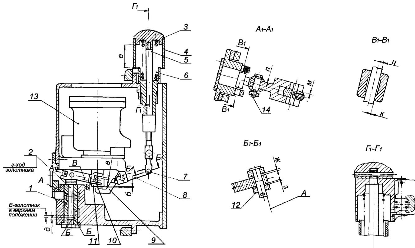
Рисунок 7.28 – Электромагнитный выключатель
