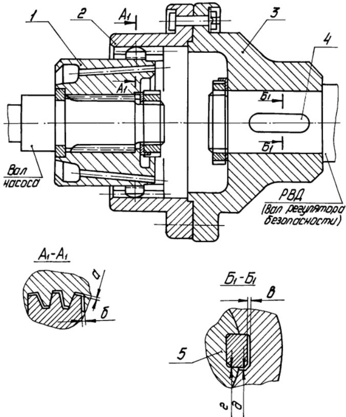
Рисунок 7.13 – Муфта зубчатая "насос – РВД"
