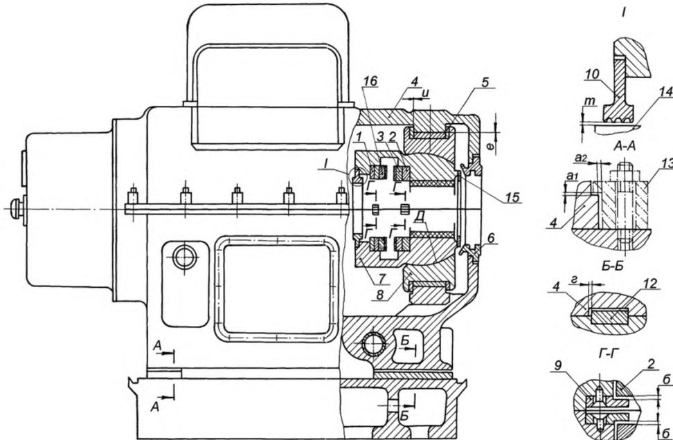
Рисунок 7.7 – Передний подшипник
