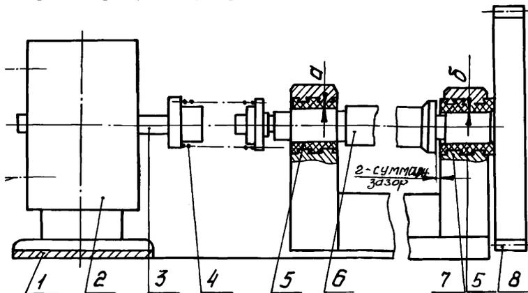
*Зацепление шестерни поз. 6 с шестерней насоса регулирования.*
