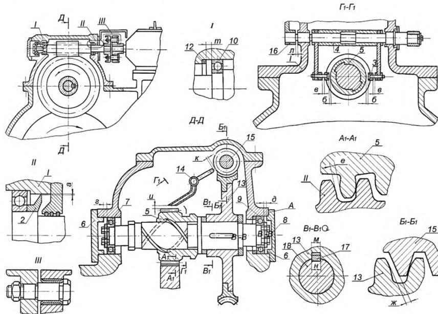
Рисунок 7.9 – Валоповоротное устройство
