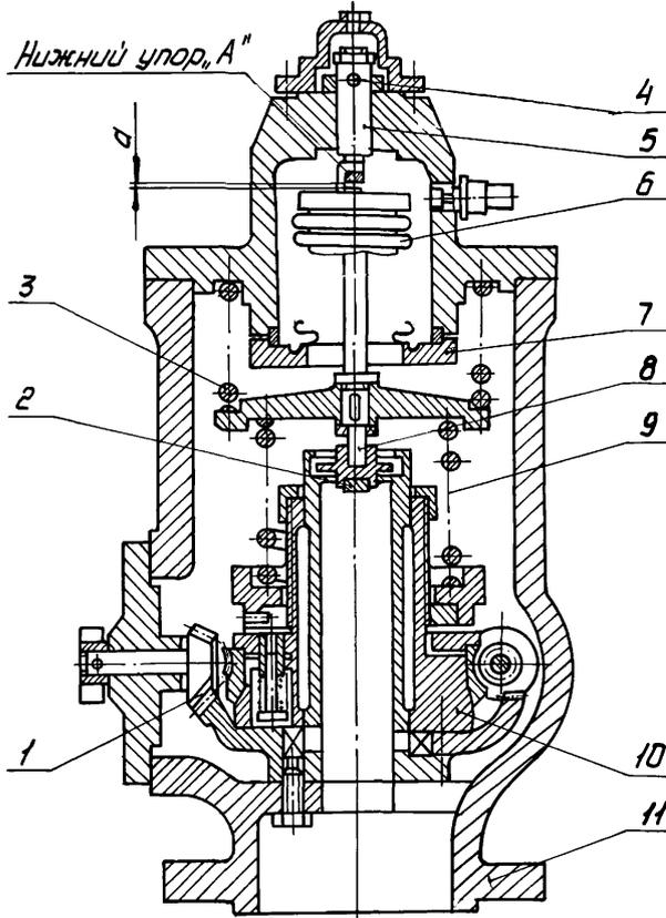
Рисунок 7.20 – Регулятор давления 1,2–2,5 ата, регулятор давления 10–18 ата
