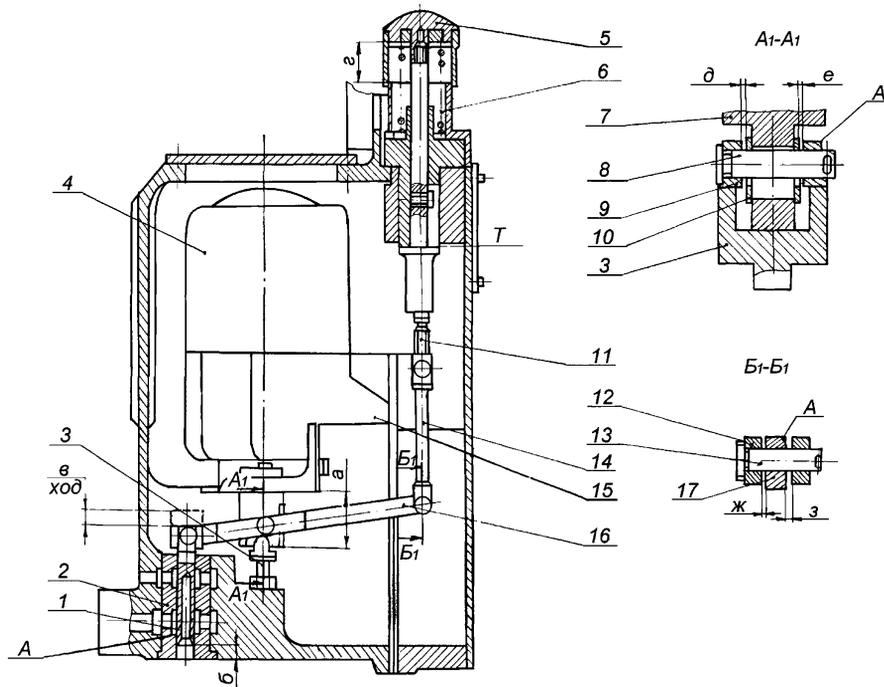
Рисунок 7.27 – Электромагнитный выключатель
