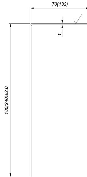
Рисунок 6 - угол откосный УО-1; 2; 3; 4
