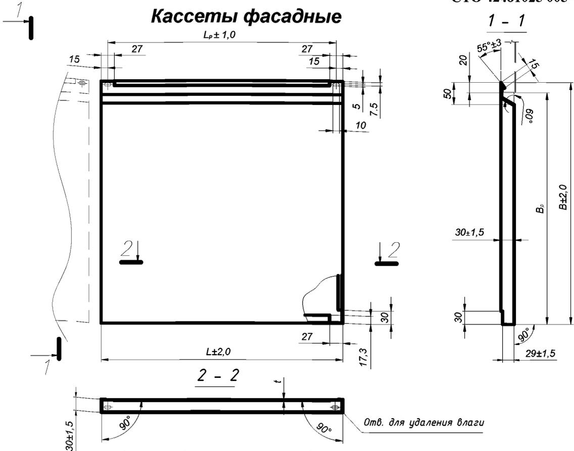
Рисунок 2 – кассета фасадная КФ 2
