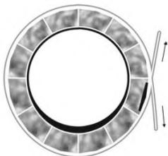
При наложении на трубу конструкция немного провисает, а ее сегменты принимают форму равнобедренной трапеции.
