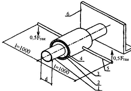
1 – стальная труба; 2 – изоляция из ППУ; 3 – труба-оболочка из полиэтилена;
