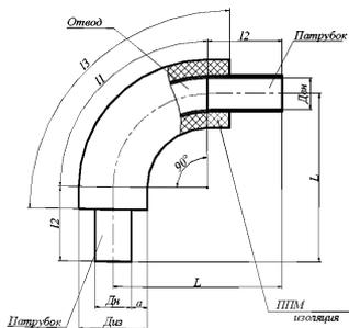
Рисунок Ж.1 - Отвод с углом поворота
