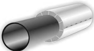
Верхним краем покровного слоя накрыть горизонтальный стык, закрепить его на планке фиксации оцинкованными скобами с помощью механического степлера.
