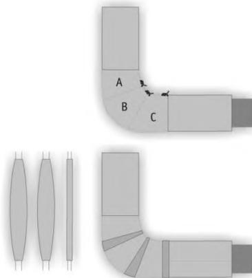
«Рыбки» накладываются на угол поворота и фиксируются оцинкованной проволокой.
