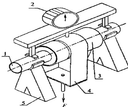
1 – стальная труба; 2 – индикатор; 3 – труба-оболочка из полиэтилена и изоляция из ППУ; 4 – приспособление для приложения нагрузки; 5 – опора
