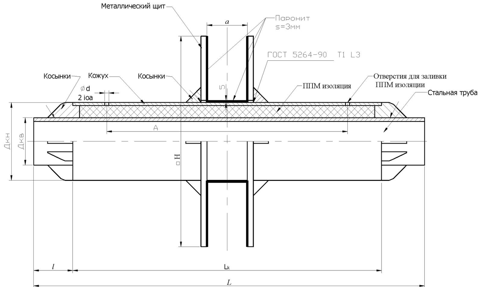
Рисунок Ж.6 - Неподвижная опора в ППИ изоляции
