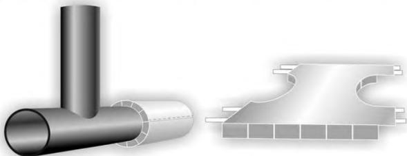
При монтаже конструкции СТУ на отвод выполнить дополнительные технологические вырезы для обеспечения плотного прилегания теплоизоляционных конструкций. Зону контакта конструкций покрыть антикоррозионной мастикой. Плотно надвинуть вертикально расположенную конструкцию СТУ.
