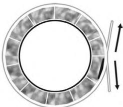
При обтягивании стеклобандажной ленты компенсационный сегмент сжимается, что обеспечивает плотное облежание конструкции по всему диаметру трубы.
