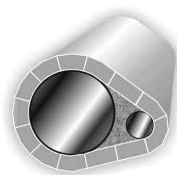
Конструкция накладывается горизонтальным швом на боковой части трубы большего диаметра.
