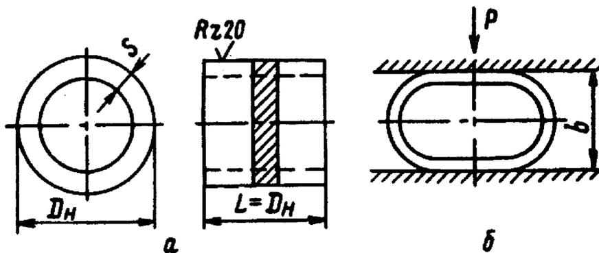
*a* — размеры образца; *б* — схема испытания;  $D_H$  — наружный диаметр трубы;
