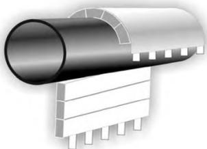
Наложить СТУ на трубопровод таким образом, чтобы при соединении краев горизонтальный стык пришелся на боковую поверхность трубы;
