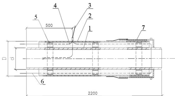
1 – стальная труба; 2 – оболочка; 3 – кабельный вывод; 4 – изоляция из ППУ;
