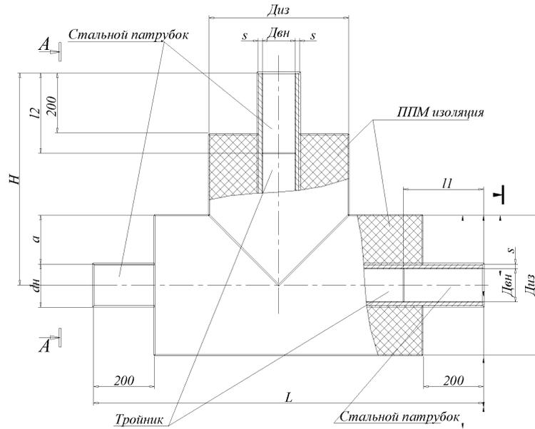
Рисунок Ж.4 - Тройник равнопроходной
