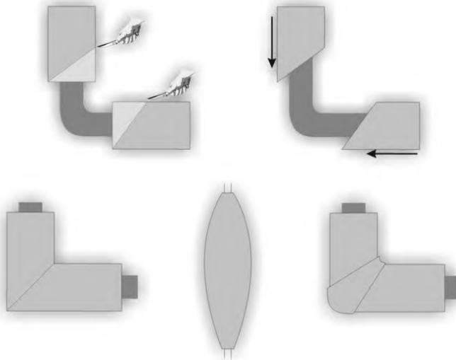
Если диаметр трубопровода значительно превышает толщину изоляционного слоя СТУ, поставляется специальный комплект для изоляции углов поворотов.
