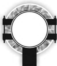
При изоляции хомутовых опор в СТУ сделать вырезы под выступы стягивающих шпилек.
