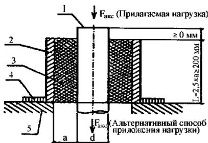
1 – стальная труба; 2 – труба-оболочка из полиэтилена; 3 – изоляция из ППУ;
