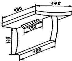
Рисунок 12.3.1 - Схема сварки таврового соединения пластин (погонов из труб) для определения технологических свойств электродов
