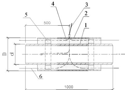
1 – стальная труба; 2 – оболочка; 3 – кабельный вывод; 4 – изоляция из ППУ;
