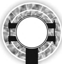
На район выступов установить второй слой СТУ с предварительно гидроизолированными торцами.
