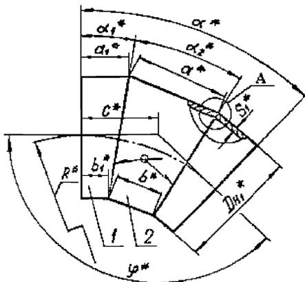
Рисунок Л.1 - Колена сварные. Геометрические размеры в соответствии с ОСТ
