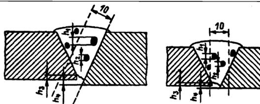
Рисунок 12.5.8 - Схема подсчета показателя концентрации дефектов ( $K_d$ ):
