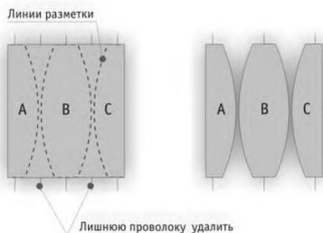
Из цельных конструкций (бандажная лента заменена на оцинкованную проволоку) по месту вырезаются «рыбки», при необходимости лишняя проволока вытаскивается из конструкции.
