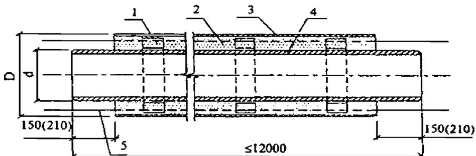
1 – центрирующая опора; 2 – изоляция из ППУ; 3 – труба-оболочка;
