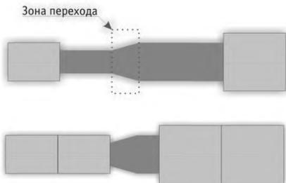
Изоляция СТУ трубопровода меньшего диаметра подводится вплотную к зоне перехода.
