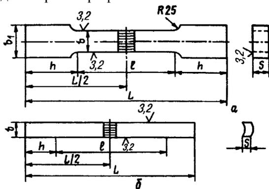
*a* — для толстостенных труб ( $S \geq 12$  мм); *б* — для тонкостенных труб ( $S < 12$  мм)
