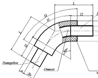
Рисунок Ж.2 - Отвод с углом поворота
