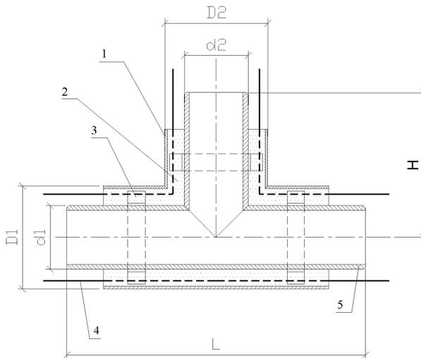
1 – оболочка; 2 – изоляция из пенополиуретана; 3 – центрирующая опора;
