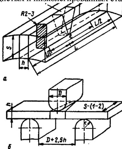
*a* — схема вырезки и размеры образца; *б* — схема испытаний;  $D = 2h$  — диаметр пуансона;
