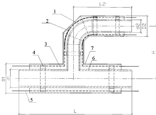
1 – стальной отвод; 2 – электроизоляционная трубка (для труб со стальной оболочкой);
