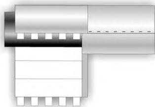
Следующую конструкцию СТУ плотно надвинуть на предыдущую таким образом, чтобы свободный край покровного слоя полностью перекрыл вертикальный стык, а теплоизоляционные сегменты СТУ, в свою очередь, были плотно прижаты к предыдущим для исключения «тепловых мостиков»;
