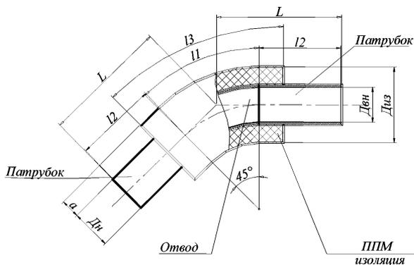
Рисунок Ж.3 - Отвод с углом поворота 45°
