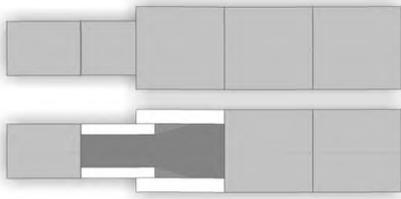
СТУ с предварительно гидроизолированным торцом монтируется на зону перехода с перекрытием.
