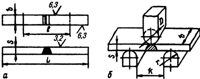
$$b = 1,5s, \text{ но не менее } 10 \text{ мм}; l = L/3; D = 2s; r = s, \text{ но не более } 25 \text{ мм}; k = 2,5D$$
