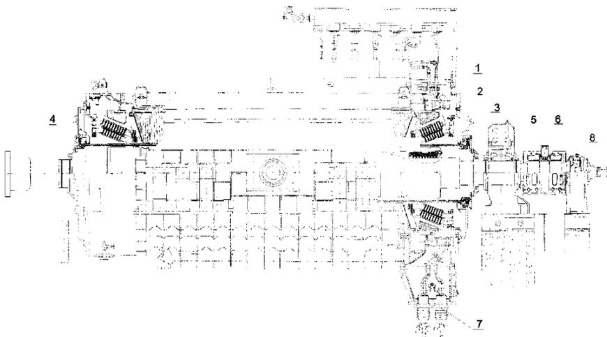
1 – статор; 2 – щит наружный; 3 – ротор; 4 – лабиринтное уплотнение вала; 5 – подшипник; 6 – щеточный аппарат; 7 – вывод концевой; 8 – водоподвод.
