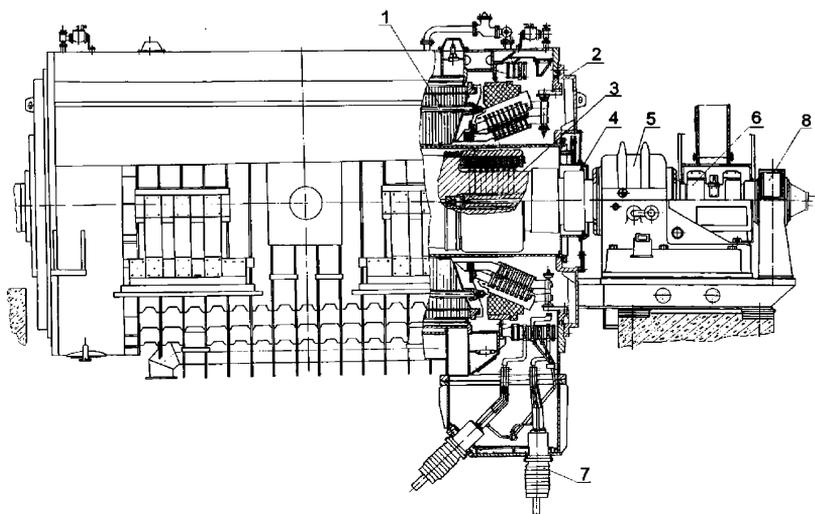
1 – статор; 2 – щит наружный; 3 – ротор; 4 – лабиринтное уплотнение вала; 5 – подшипник; 6 – щеточный аппарат; 7 – вывод концевой, 8 – водоподвод.
