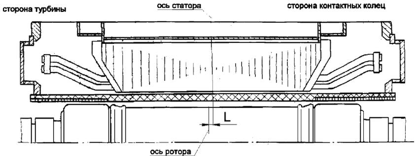
Рисунок 8.1 - Установочный размер при сборке турбогенератора.
