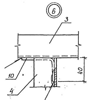
Сварка по ГОСТ 5264-80, тип соединения Н1, катет шва 3 мм.
