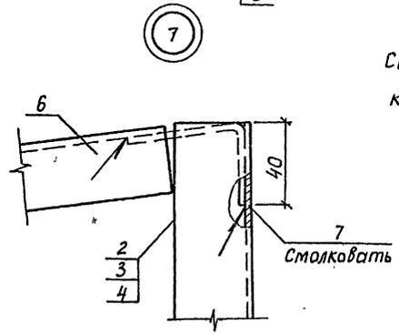
Сварка по ГОСТ 5264-80, тип соединения Н1, катет шва 3 мм.
