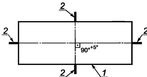
1 — контролируемый образец полимерной ленты; 2 — места измерения
