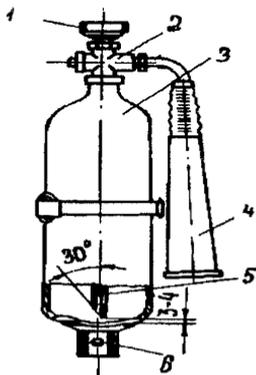
Переносной углекислотный огнетушитель ОУ-2 состоит:
