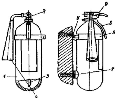
Переносной углекислотный огнетушитель ОУ-5 (ОУ-8) состоит:
