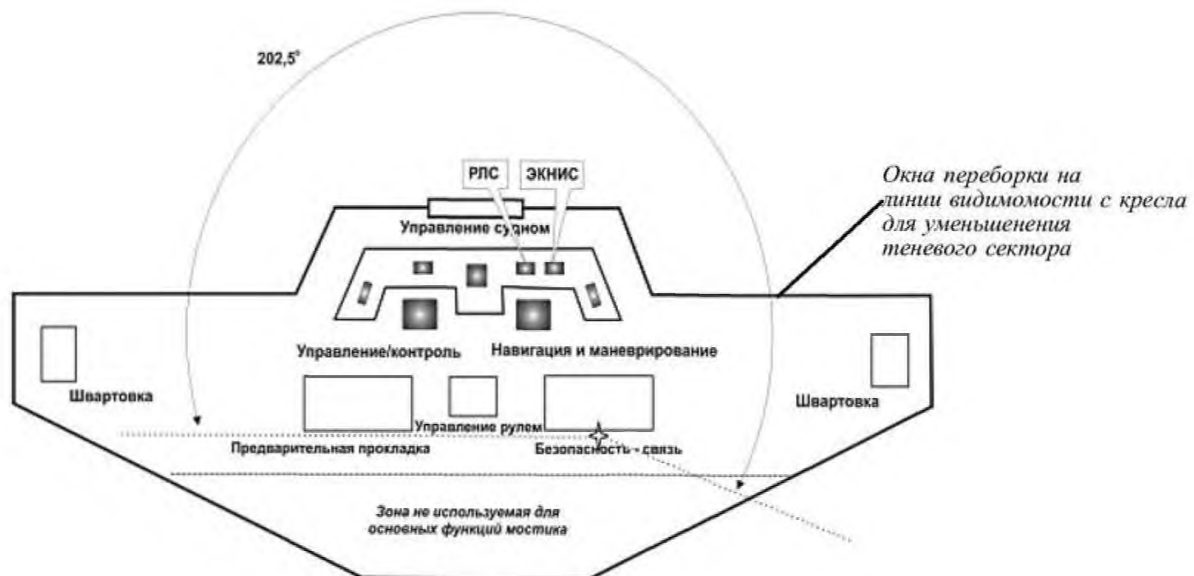
Рис. 2.5.17-2 Требуемая зона видимости с поста радиосвязи, во время контроля и эпизодического кратковременного использования оборудования ГМССБ вахтенным помощником. Судовождение с использованием системы электронных карт (ЭКНИС) — место управления судном на пульте
