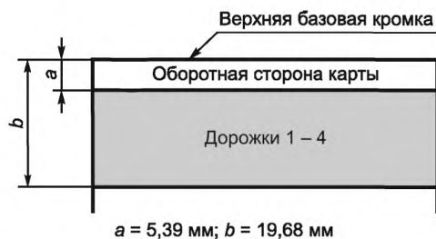
Рисунок 8 — Расположение и высота полосы при четырех дорожках
